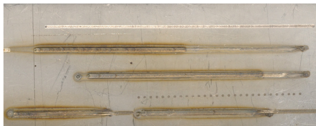
Fig. 3.15. – Aspectul vizual al experimentărilor preliminare pentru verificarea soluției constructive (treceri cu fascicul laser și treceri laser-WIG pulsat)
