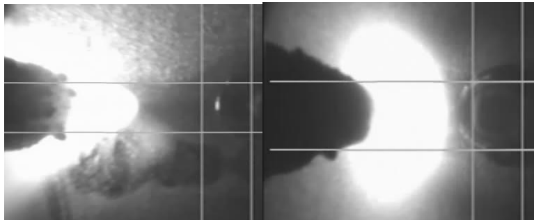
Fig. 4.11. Devierea arcului WIG datorită suflajului magnetic și a gazului de protecție laser în zona curentului de bază și stabilizarea acestuia prin creșterea ratei de umplere procesului WIG
