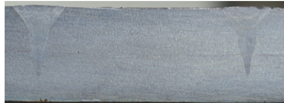
Fig. 4.49. Forma trecerilor cu varianta WIG cc-laser
