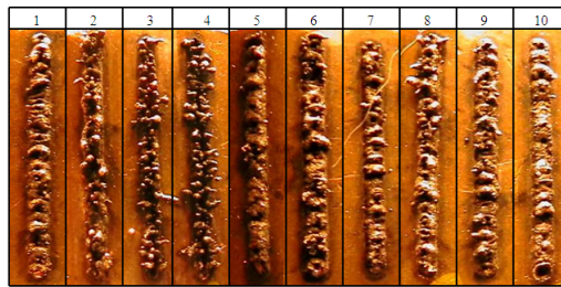
Fig. 5.117. Treceri cu fascicul laser pe MMC nanostructurat (CuAlSi) [21]
