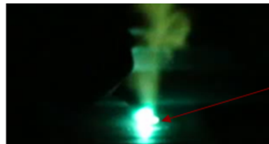
Fig. 4.5. Detaliu plasmă generată de fasciculul laser și devierea arcului WIG către fasciculul laser [19]
