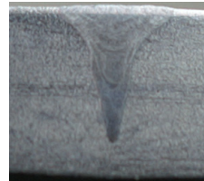
Fig. 2.47. Secțiunea transversală a sudurii laser pulsat – WIG cc [19] a– laser-WIG; b.- WIG-laser
