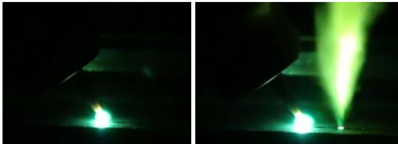
Fig. 4.20. Devierea arcului WIG spre plasma generată laser în zona curentului de vârf ( I_{\text{med}}=15\text{A} , a=6\text{mm} , \text{ratWIG}=40\% )
