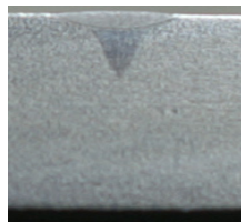
Fig. 2.47. Secțiunea transversală a sudurii laser pulsat – WIG cc [19] a– laser-WIG; b.- WIG-laser
