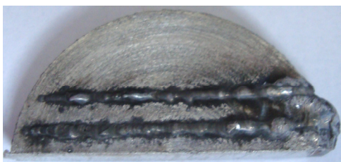
Fig. 5.120. Treckeri WIG-laser pulsat 30%SiC + Al turnat
