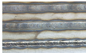
Fig. 4.31. Treceri WIG-laser pulsat fără gaz de protecție laser – aspect vizual (de sus în jos trecerile WL-ng 0001-1 la 0001-3)
