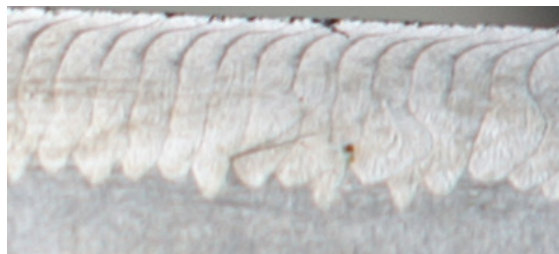
Fig. 4.44. Secțiune longitudinală – variații de pătrundere
