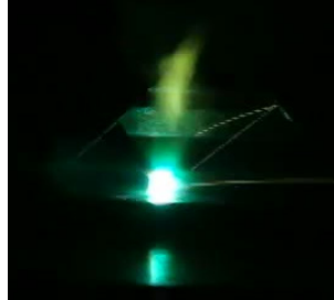
Fig. 4.33. Stropiri in cazul WIG-laser pulsat fără gaz de protecție laser
