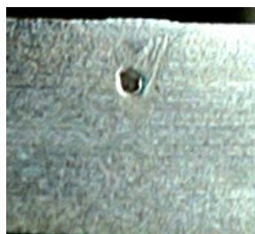
Fig. 4.46. Sudură simetrică (WIG: 20A, 1Hz, 60%)
