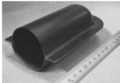
Figura 1.31. Volet fabricat prin lipirea a două părți identice din aliajul amorf masiv Zr_{55}Cu_{30}Al_{10}Ni_5 (prelucrare din [89])
