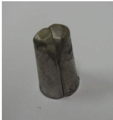
Figura 7.4. Produsul sub formă de capac obținut din aliaj amorf masiv
