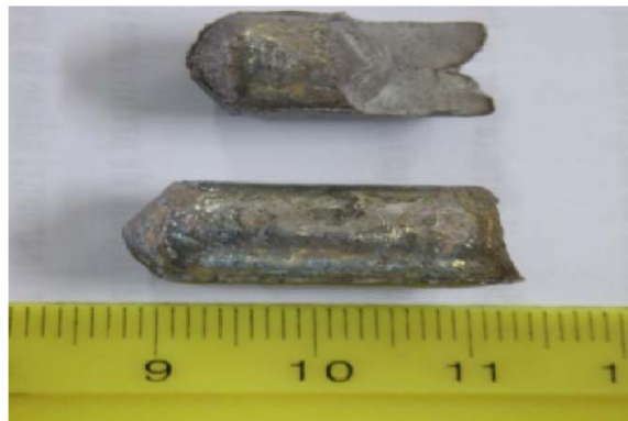
Figura 4.3. Aliajul primar obținut sub formă de bară
