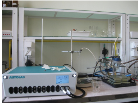
Figura 6.49: Instalația folosită pentru determinarea comportamentului la coroziune
