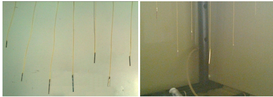
Figura 6.46. Probele suspendate în camera de ceață salină
