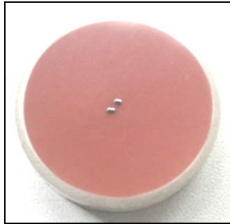
Figura 6.32. Probă folosită la testul de nanoindentare
