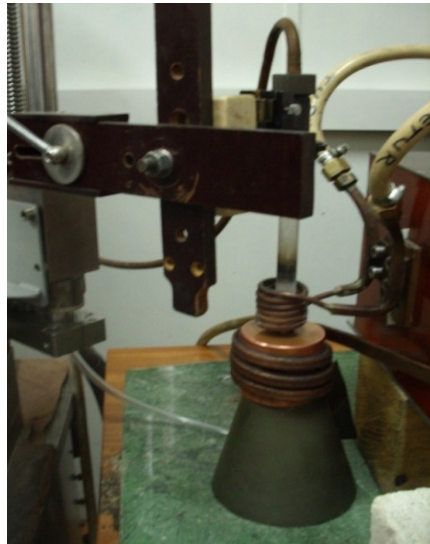
Figura 4.14. Procedul de turnare în matrița prin aspirație
