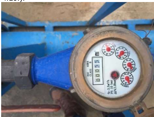
Figura 4.20. Debitmetru cu precizie maximă 0,0001 m 3
