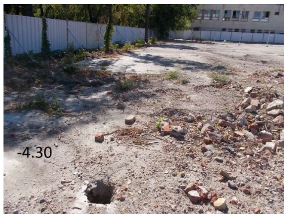
Figura 4.29. Nivel freatic interceptat la cota -4.30
