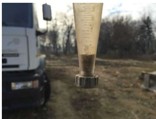
Figura 4.24. Conul de sedimentare - Valoare 1,00 ml. - 1,80 gr.
