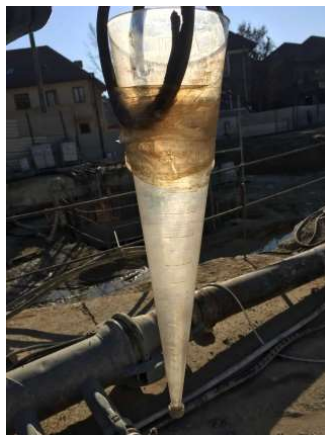
Figura 4.23. Con etalon de sedimentare a particulelor fine din apă extrasă
