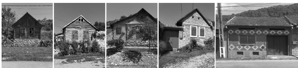
Fig. 3.1 Casa din mediul rural, prin materialitate: 1 – lemn și fundații din piatră, Carașova; 2 – lemn și fundații din piatră, Potoc; 3 – pământ, împletitură și fundații din piatră, Carașova; 4 – piatră, Socolari; 5 – cărămidă, Măru; sursa: fotografiile proprii
