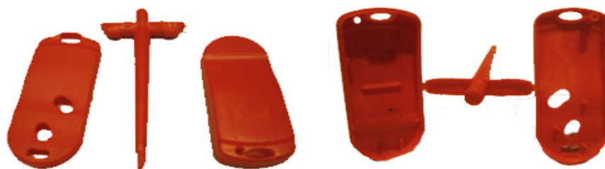
Fig. 5.16 Piese injectate din polipropilenă cu colorant roșu fără defecte
