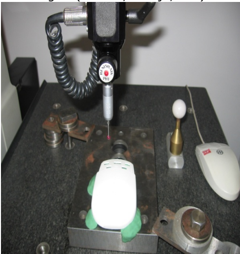
Fig. 3.16 Măsurarea piesei cu mașina TESA 3D MicroMS 343 DCC [Cosma, 2008.a]
