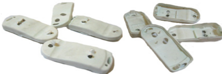
Fig. 5.15 Piese injectate din polistiren cu defecte
