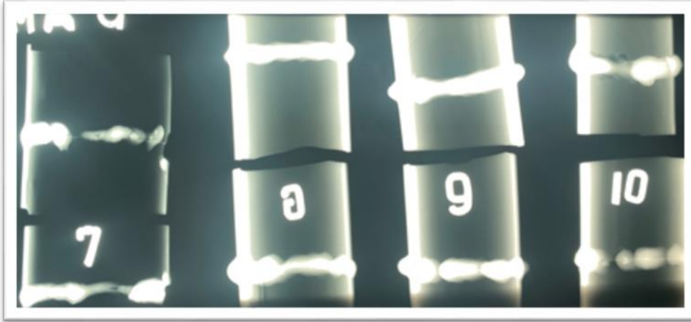
Fig. 6.16 Examinări cu RX pentru sudura MAG
