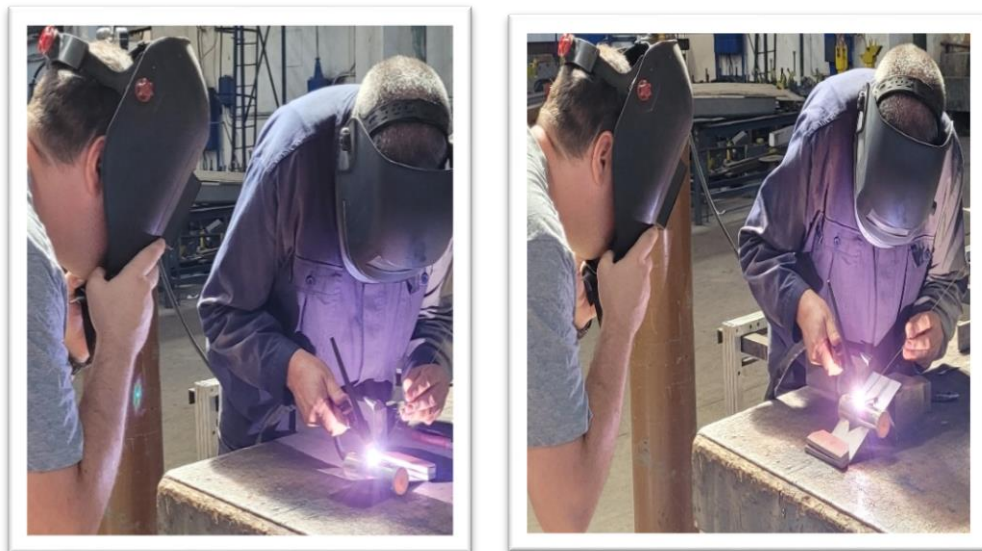
Fig.5.45 Executarea sudurii cu arc electric în mediu de gaz protector cu electrod nefuzibil
