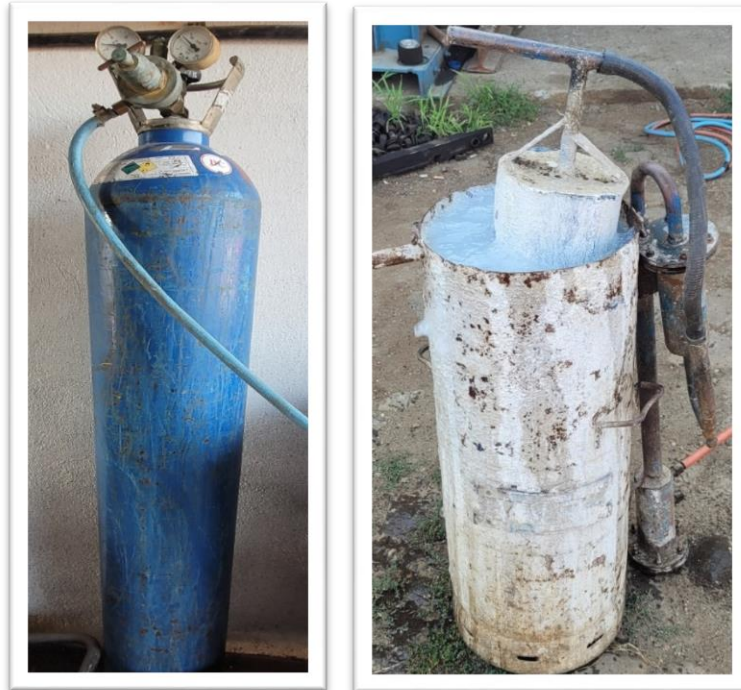
Fig.4.3 Butelia cu oxigen și generatorul de acetilenă utilizate la realizarea experimentului
