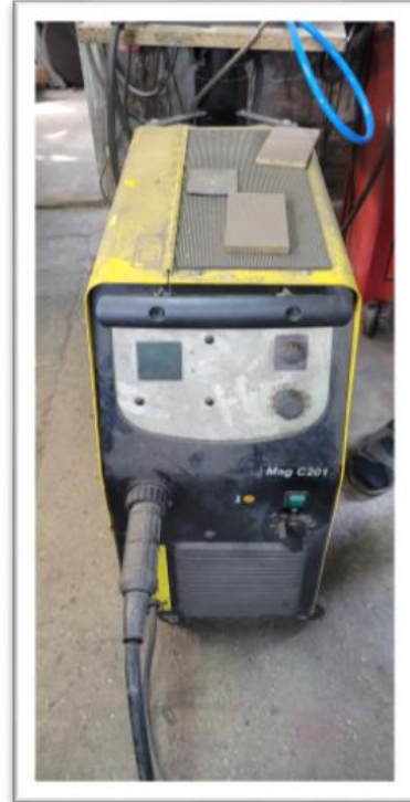
Fig.5.3 Aparat de sudură Origo Mag C201 utilizat la realizarea experimentului
