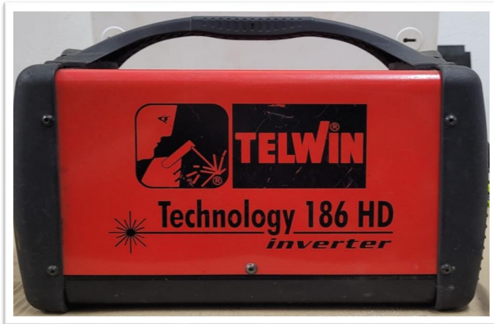
Fig.4.33 a Aparat de sudură cu inverter utilizat la realizarea experimentului
