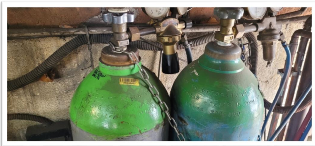
Fig.5.4 Butelie gaz, 82% Argon 18% CO2 utilizat la realizarea experimentului
