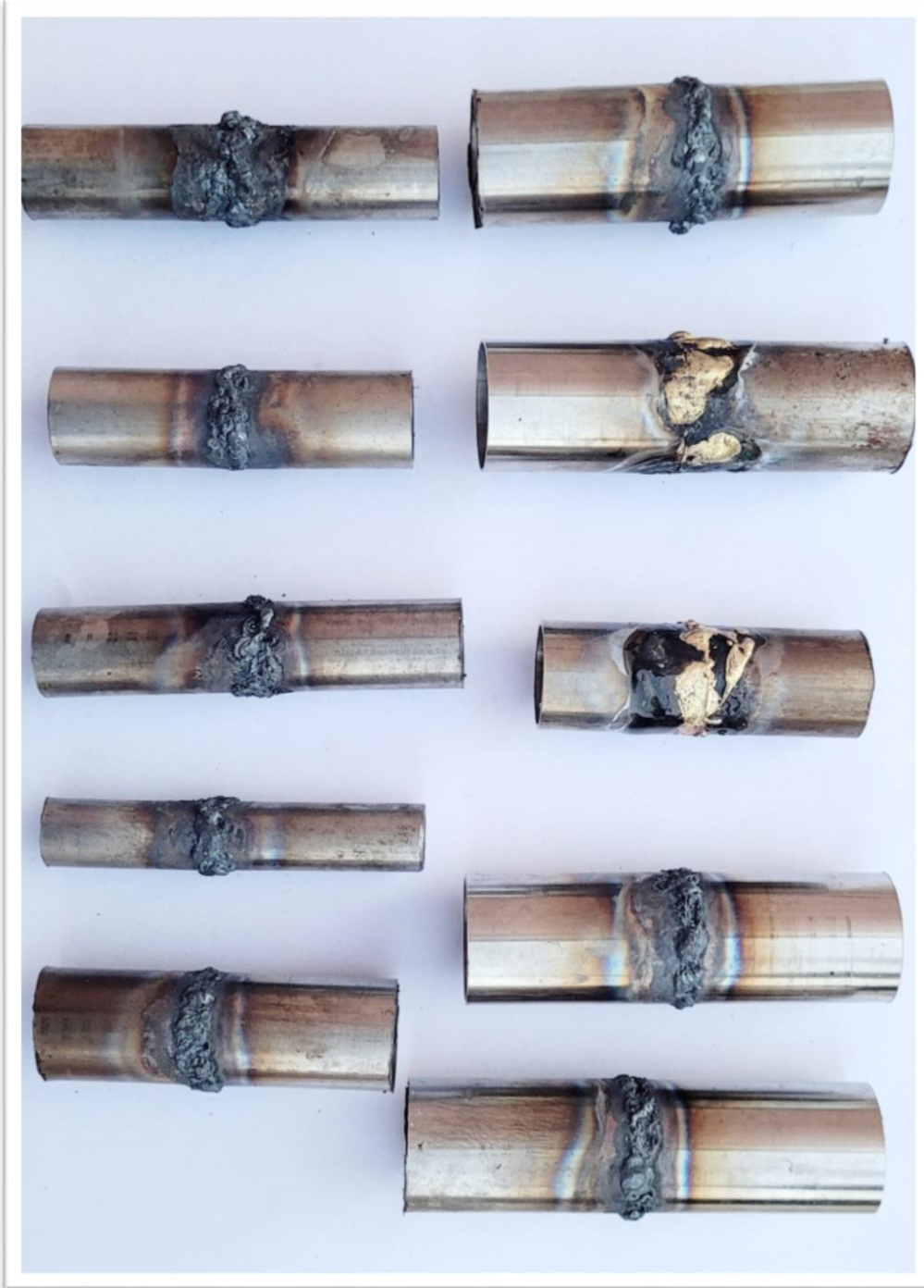
Fig.4.6 Țevi cu sudură oxiacetilenică utilizate la realizarea experimentului
