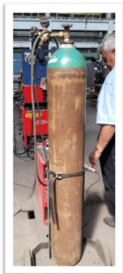
Fig.5.40 Butelie Argon, gaz protector, utilizat la realizarea experimentului
