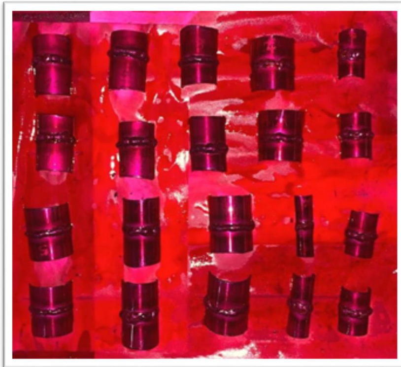
Fig. 6.15 Examinări cu lichide penetrante pentru sudura MAG
