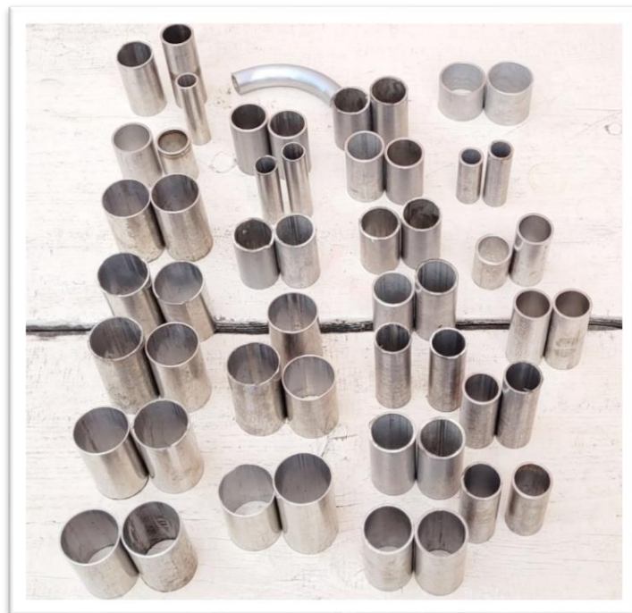
Fig.5.43 Materialele pregătite pentru sudare cu arc electric în mediu de gaz protector cu electrod nefuzibil
