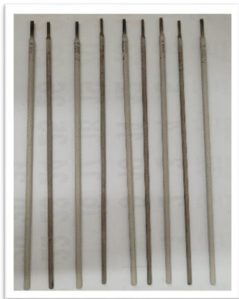
Fig.4.34 Electrozi înveliți cu diametrul de 1,6 și 2 mm utilizați la realizarea experimentului
