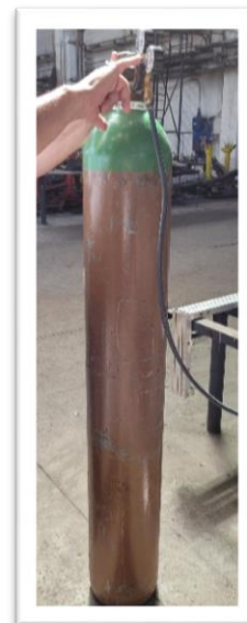
Fig.5.41 Butelie Argon, gaz la rădăcină, utilizat la realizarea experimentului
