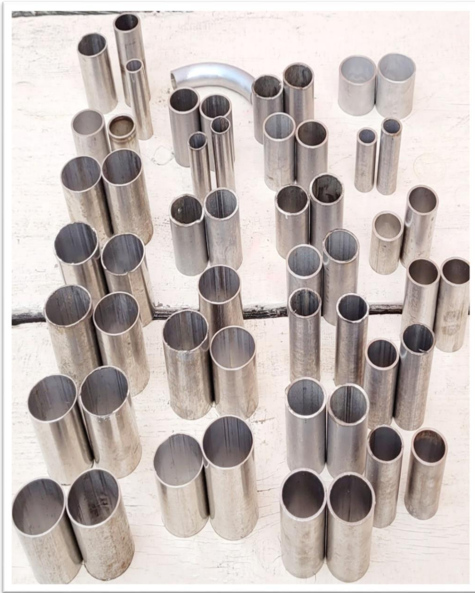
Fig.5.7 Materialele pregătite pentru sudare cu arc electric în mediu de gaz protector cu electrod fuzibil
