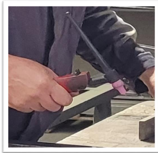
Fig.5.42 Pistolet sudare cu electrod nefuzibil de wolfram, utilizat la realizarea experimentului
