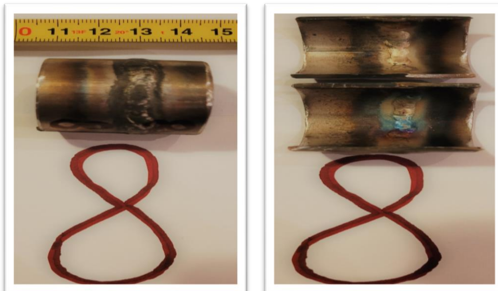
Fig.5.56 Proba 8 din experimentul cu sudură cu arc electric în mediu de gaz protector cu electrod nefuzibil
