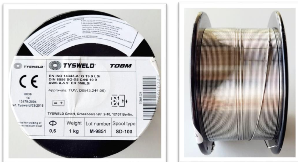
Fig.5.6 Sârmă pentru sudură din inox, diametrul 0,6 mm, utilizată la realizarea experimentului
