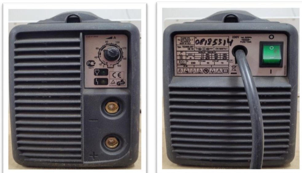
Fig.4.33 b Aparat de sudură cu inverter utilizat la realizarea experimentului
