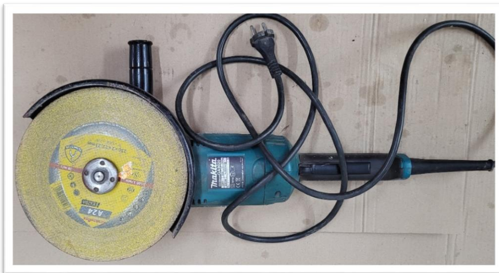
Fig.4.2 Polizor unghiular utilizat la realizarea experimentului
