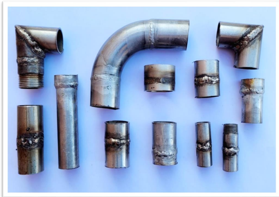
Fig.4.36 Țevi cu sudură manuală cu electrod învelit utilizate la realizarea experimentului
