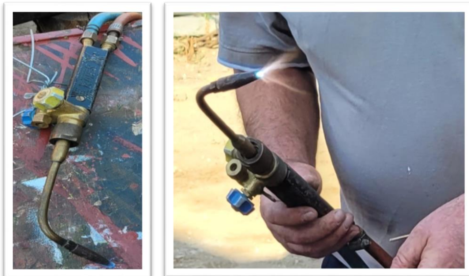
Fig.4.4 Arzătorul / Lancea pentru sudare utilizat la realizarea experimentului
