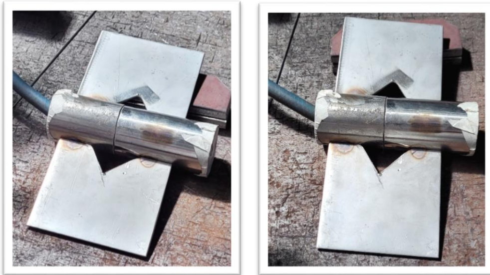
Fig.5.44 Executarea sudurii cu arc electric în mediu de gaz protector cu electrod nefuzibil
