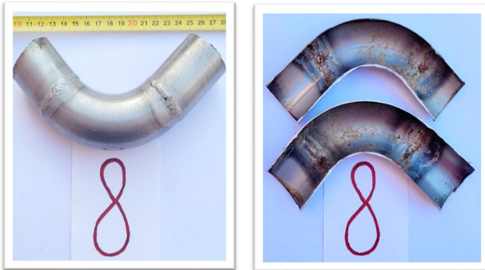
Fig.4.44 Proba 8 din experimentul cu sudură manuală cu electrod învelit
