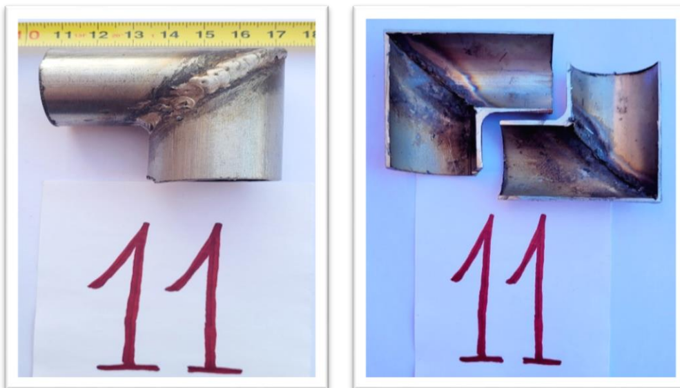
Fig.4.47 Proba 11 din experimentul cu sudură manuală cu electrod învelit
