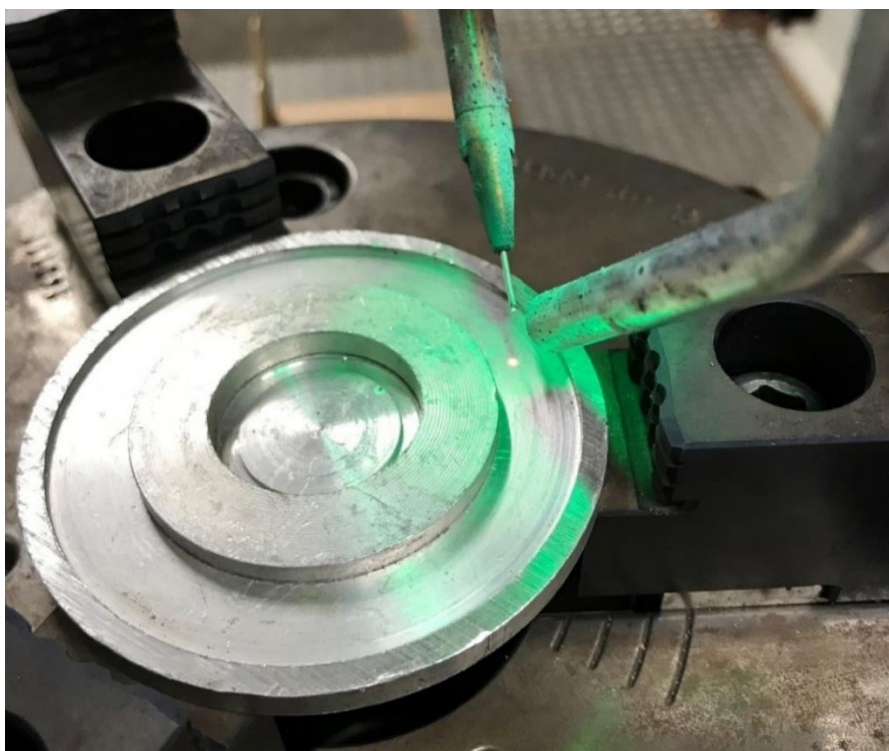
Fig. 3.8 Dispozitiv de poziționare și fixare a probelor pentru sudo-brazare
