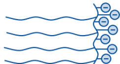
Fig. 3.9. Superplastifianți cu lanțuri lungi și încărcătură energetică diferită [98].
