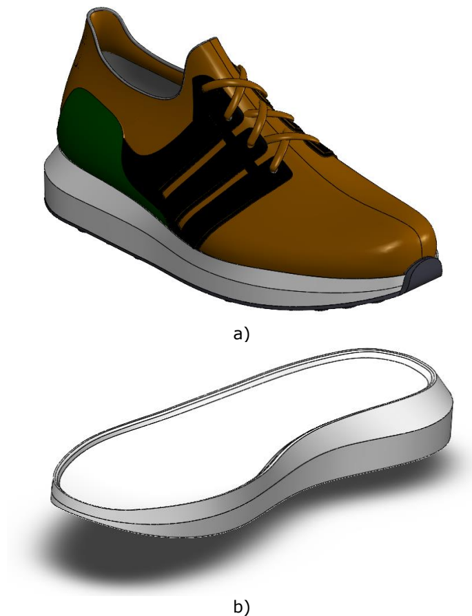
Fig. 5.1. Modelul CAD pentru încălțăminte sportivă (a) și modelul CAD al părții mediane a tălpii (b)
