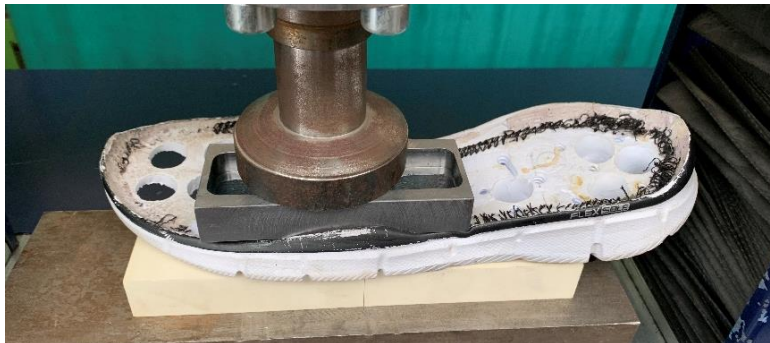
Fig. 2.4. Prelevarea epruvetelor de tracțiune
