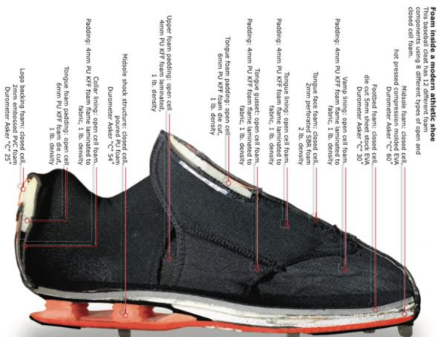
Fig. 1.13. Distribuția spumelor celulare într-o pereche de pantofi de sport [7]
