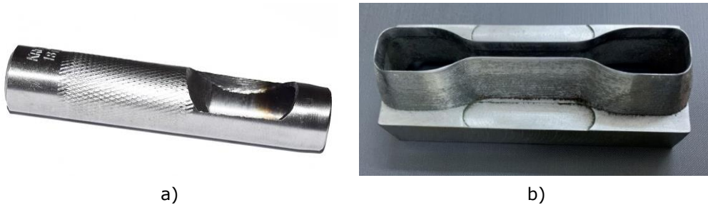
Fig. 2.3. Preducele destinate debitării epruvetelor de compresiune (a) și de tracțiune (b)
