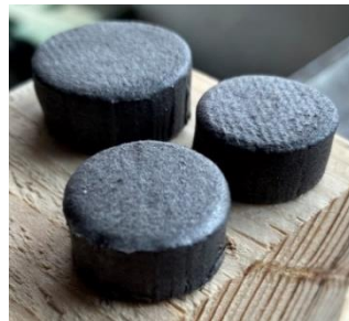
Fig. 2.8. Epruvetele prelevate din spuma EVA utilizată în fabricarea căștii de protecție
