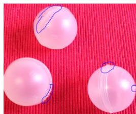
Figura 3.6. Bile brute cu bavuri tehnologice pe cordonul de sudură.
