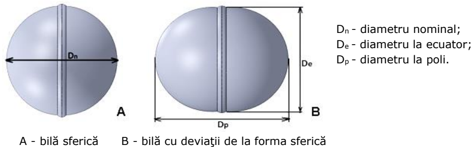
Figura 4.16. Notarea diametrelor exterioare ale bilelor sudate.
