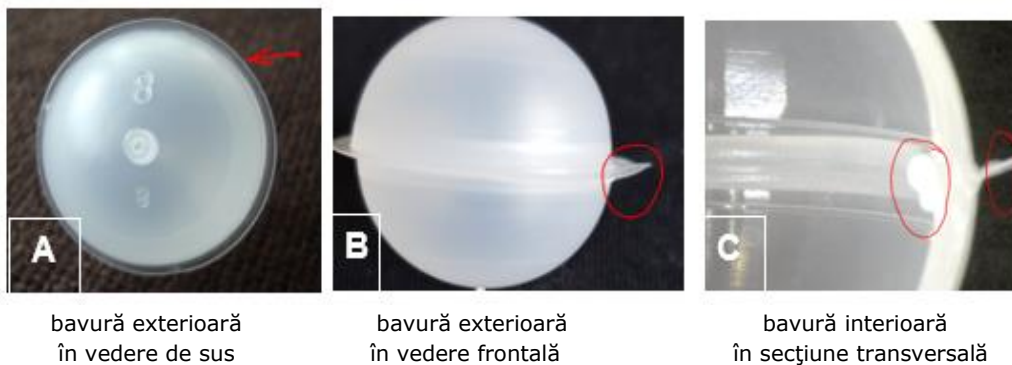
Figura 4.27. Defecte vizuale ale bilelor sudate cu radiații infraroșii.
