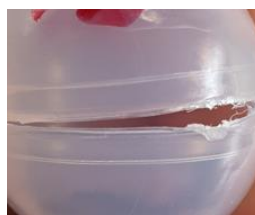
crăpături în cordonul de sudură
