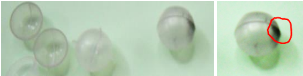
crăpături pe cordonul de sudură
