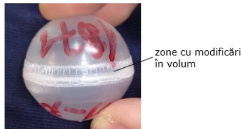
Figura 5.14. Bilă de deo roll neșlefuită, obținută prin sudare cu ultrasunete la frecvența de 20 kHz, supusă la compresiune pe direcție polară, cu apariția de zone cu modificări în volum.
