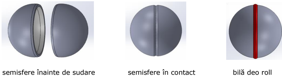
Figura 3.5. Tehnologia alternativă de obținere a bilelor prin sudarea a două semisfere.
