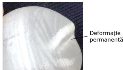
Figura 5.18. Deformații ale bilei șlefuite obținute prin sudare cu element încălzitor, supuse la compresiune pe direcție ecuatorială.
