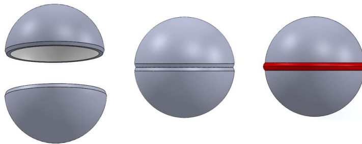
a) injectarea semisferelor b) alinierea semisferelor c) supra-injecția inelului
