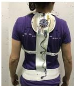
Figura 2.37. Poziționarea senzorilor accelerometrici în zona lombară [109]
