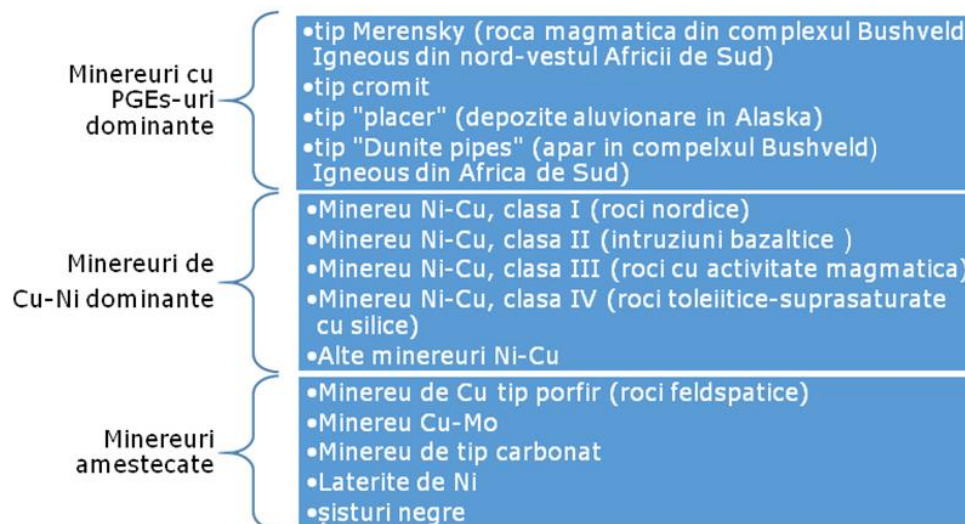
Figura 2.1. Clasificarea minereurilor din care se obțin metalele din grupul platinei[63,90]
