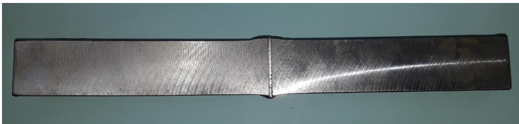
Fig.3.37 Aspectul epruvetei înainte de încercare API 5L X65M, 42"(1066.8 mm) x 31.75 mm
