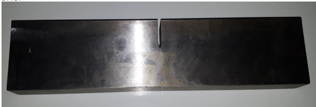
Fig.3.48 Aspectul epruvetei înainte de încercare API 5L X65M, 42”(1066.8mm)x31.75mm
