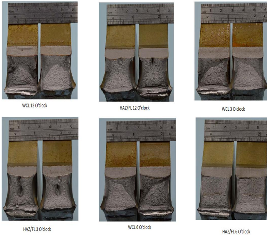
Fig.3.53 Măsurarea lungimii fisurii inițiale a_0
