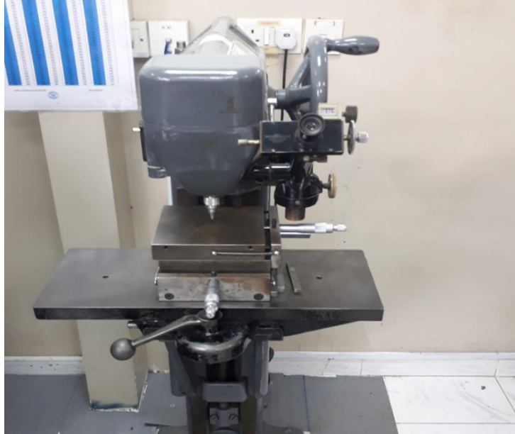
Fig.3.9 Mașina de determinare a durității Vickers cu piedestal
