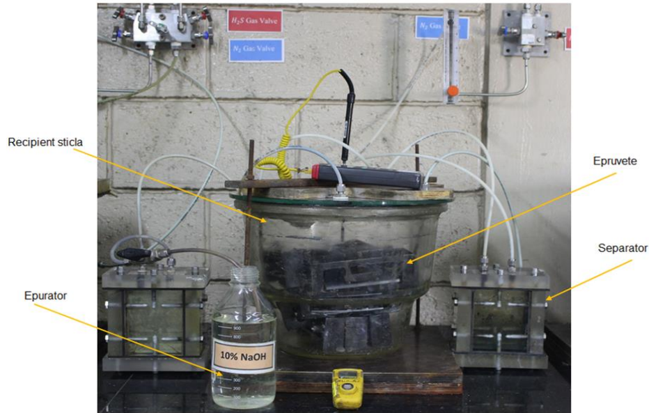
Fig.4.3 Imaginea instalației de testare la coroziune tenso-fisurantă
