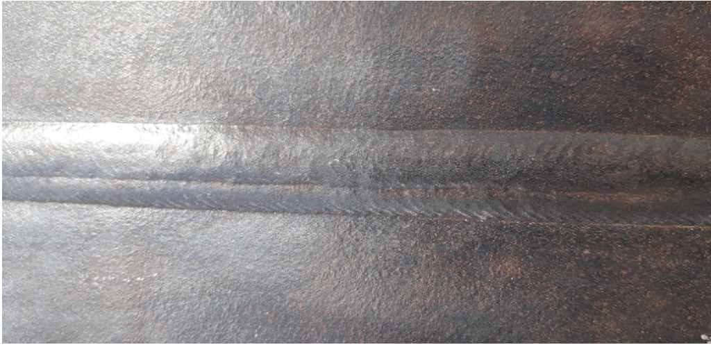
Fig.2.25. Profilul exterior al conductei sudate
