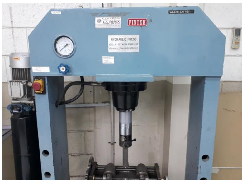
Fig.3.30 Presa hidraulică pentru îndoirea la rece
