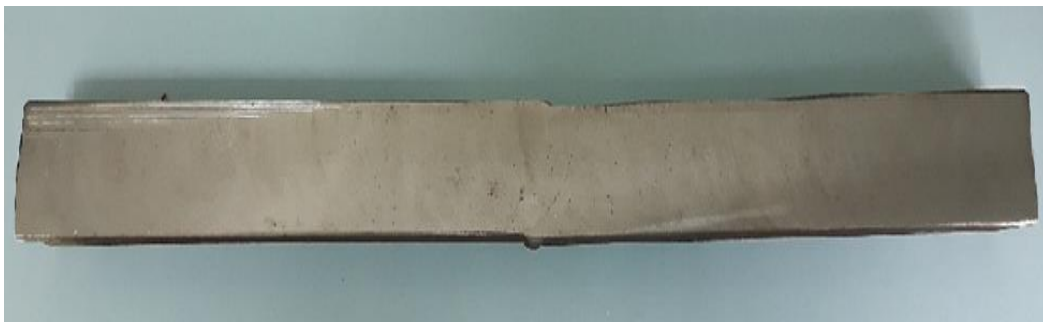
Fig.3.27. Epruveta la tracțiune pentru API 5L X65M, 42"(1066.8mm)x31.75mm
