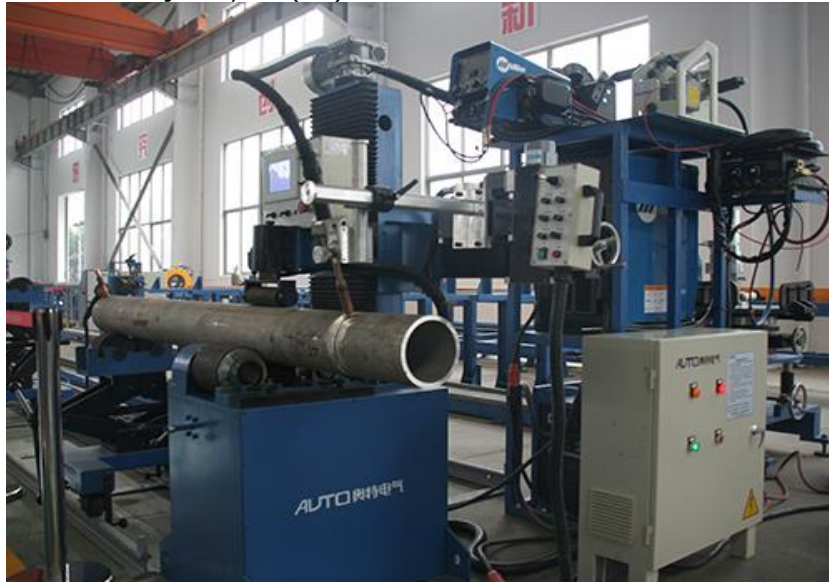
Fig.2.9 Varianta de țeavă rotitoare și sudură în poziție plană [68]
