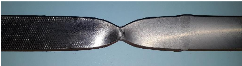
Fig.3.28 Localizarea ruperii în urma încercării la tracțiune a probelor sudate
