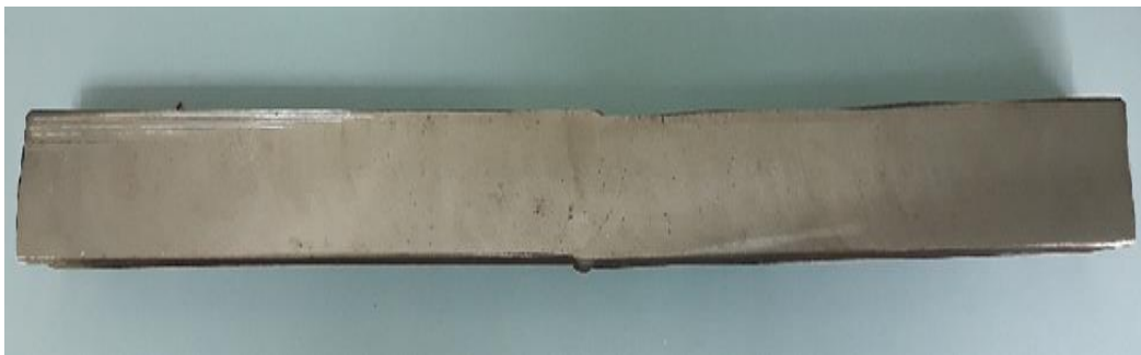
Fig.3.27. Epruveta la tracțiune pentru API 5L X65M, 42"(1066.8mm)x31.75mm
