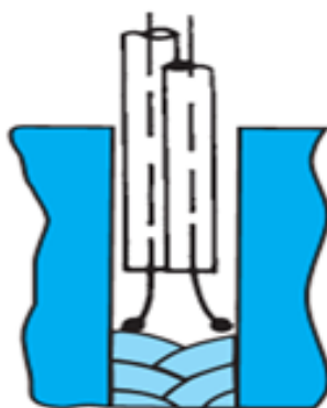
Fig.2.5 Dispunerea sârmelor la metoda tandem [103]
