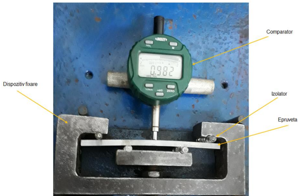
Fig.4.8 Măsurarea epruvetelor la îndoire
