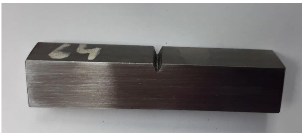
Fig.3.18. Epruveta pentru încercarea de încovoiere prin șoc
