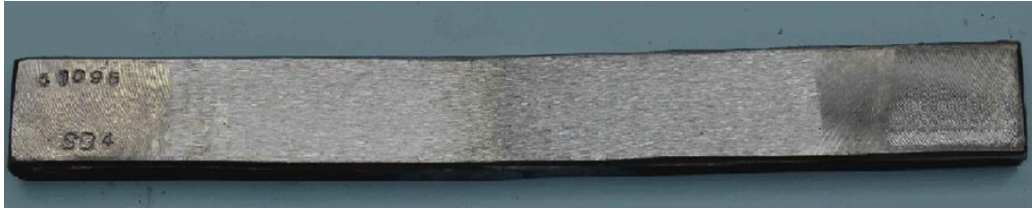
Fig.3.33. Aspectul epruvetei înainte de încercare API 5L X65M, 42'' (1066.8mm) x 31.75 mm
