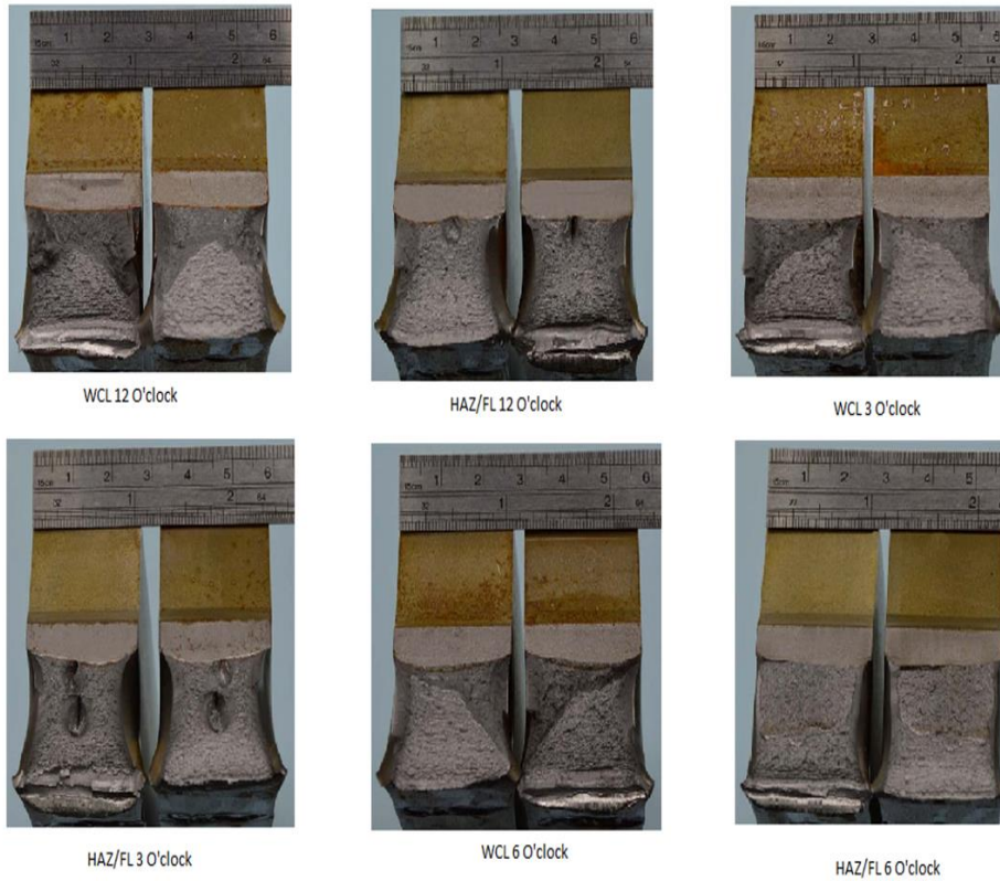
Fig.3.53 Măsurarea lungimii fisurii inițiale a_0
