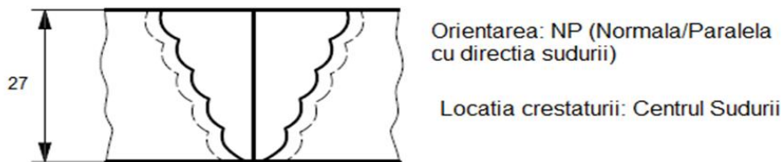
Fig.3.45 Locația creștăturii în sudură
