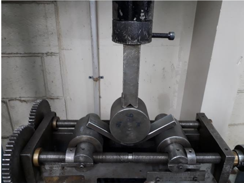
Fig.3.29 Imaginea dispozitivului de îndoire
