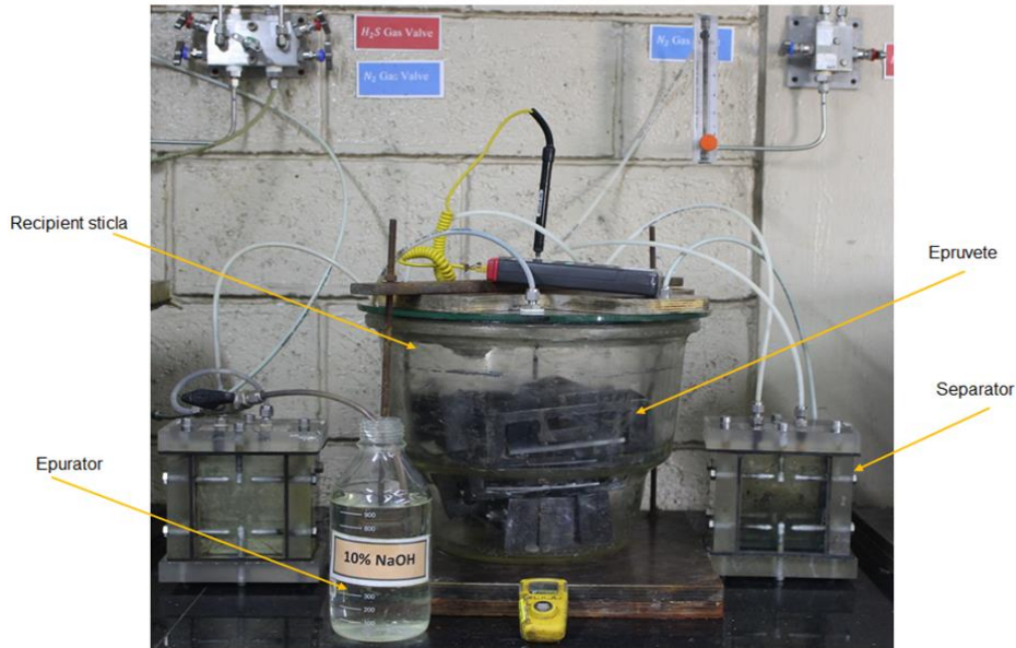
Fig.4.3 Imaginea instalației de testare la coroziune tenso-fisurantă
