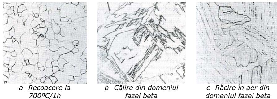
Fig. 1.13 Structuri microscopice ale titanului pur comercial și aliajelor \alpha
