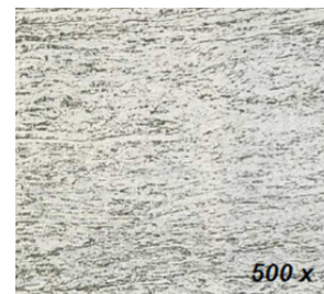
Structură laminată la cald
