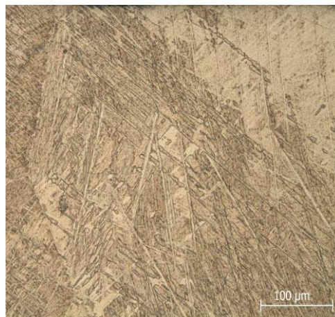
Fig. 3.9. Microstructura aliajului Ti-6Al-4V după răcire în aer de la 1050°C urmată de îmbătrânire la 550°C/aer
