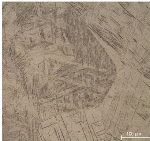
Fig. 3.18. Microstructura aliajului Ti-6Al-4V după călire în apă de la 930°C urmată de îmbătrânire la 550°C/aer
