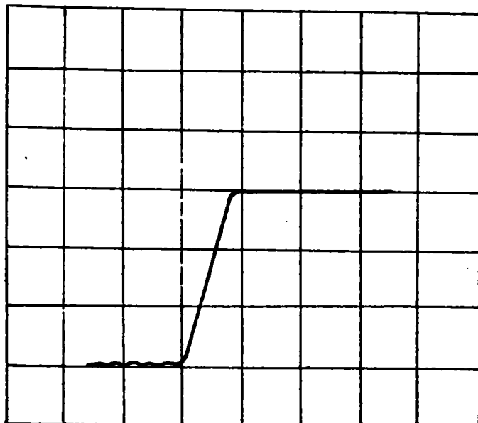
Fig.49 Timpul de stingere 20mV/div., 1μsec/div. 1 KHz; 51 μ sec; 33V/50Ω; S1/1000V. Reglaj pentru cuplaj maxim la trimer
