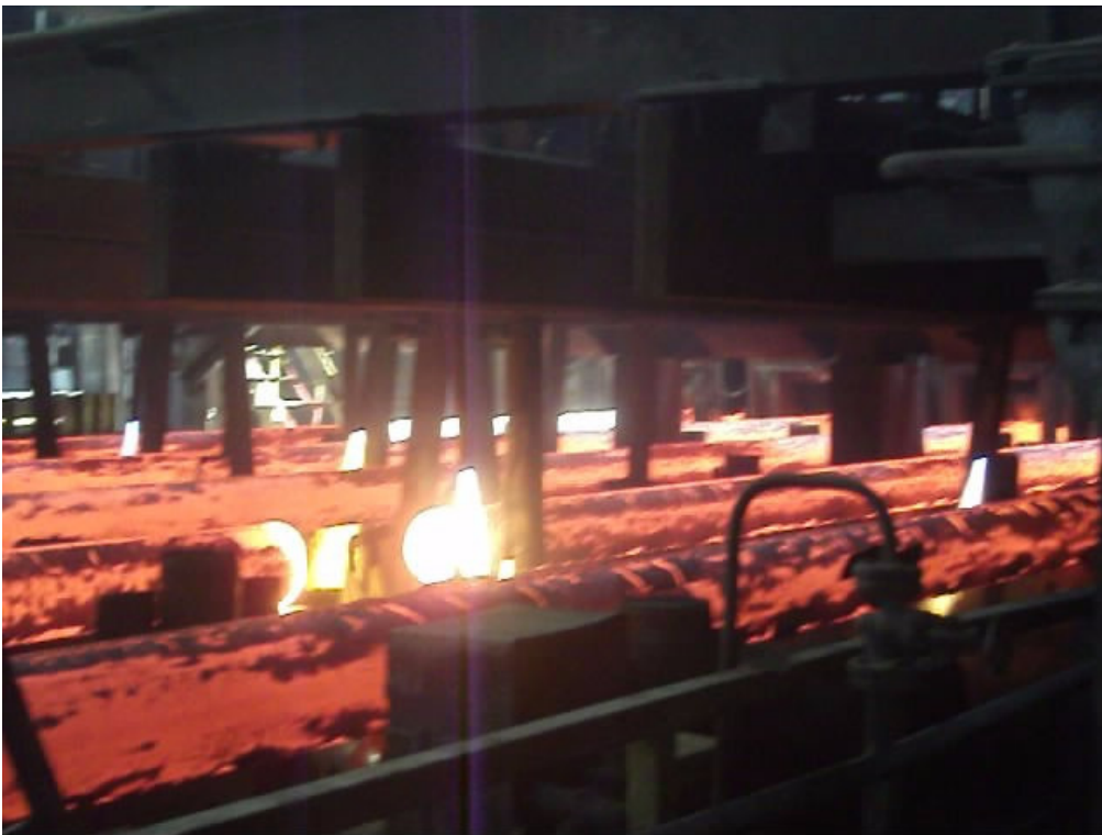
Fig. 3.12. Instalația de turnare continuă de la S.C. ArcelorMittal Hunedoara.
