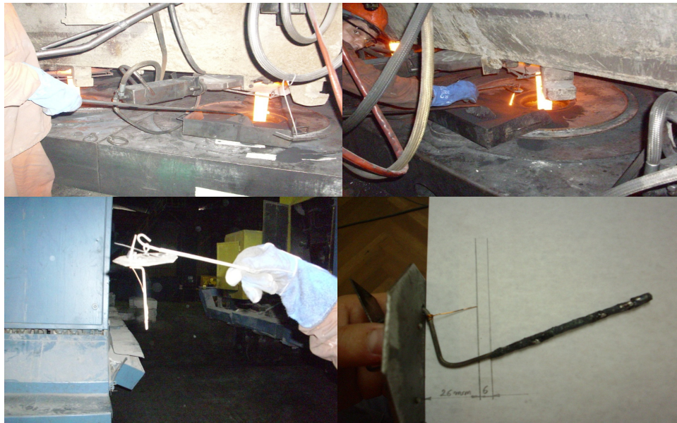
Fig 3.18. Procedul de măsură a grosimii stratului de praf din distribuitor
