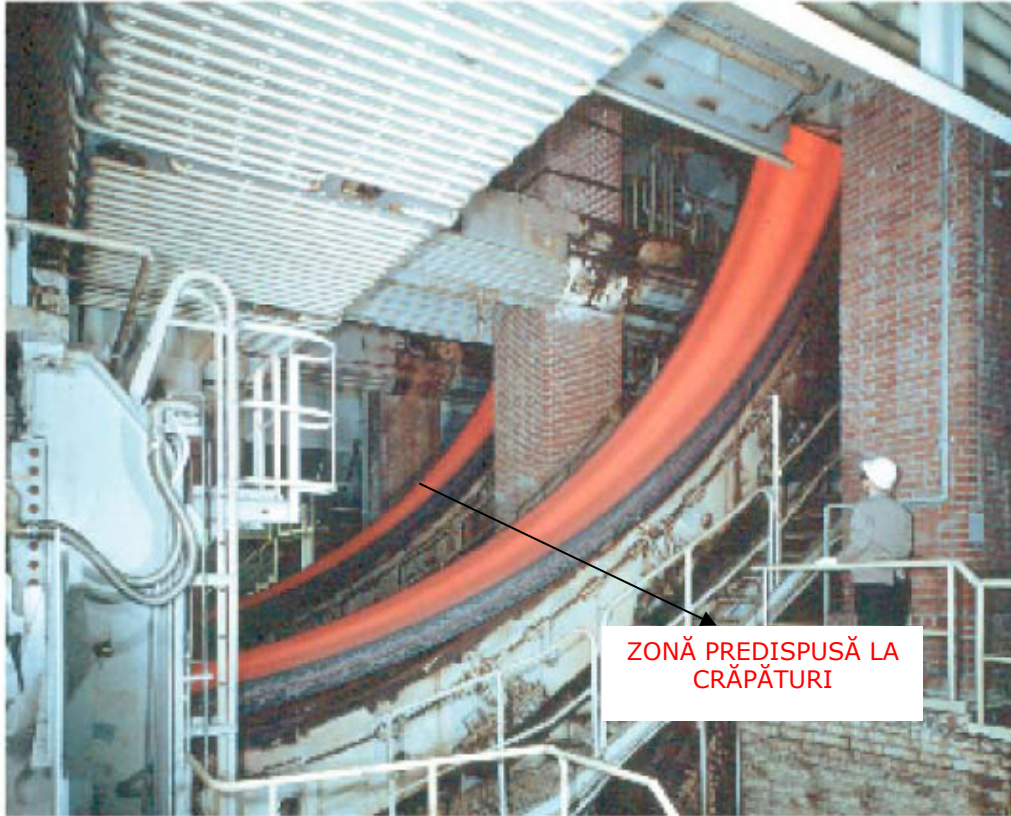
Fig.3.19. Apariția fisurilor la 600-650°C la turnarea continuă
