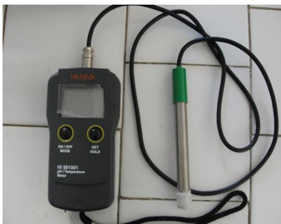
Fig. 30. pH/Termo- metru portabil [107]
