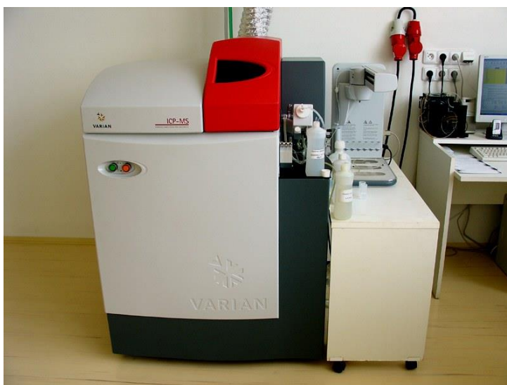
Fig.35. Spectrometru de masă cu plasmă cuplată inductiv (ICPMS) [116]
