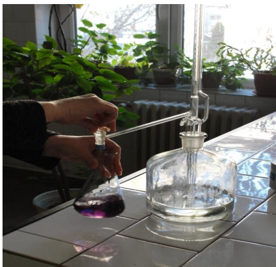
Fig.31 Instalație de titrare pentru determinarea durității apei
