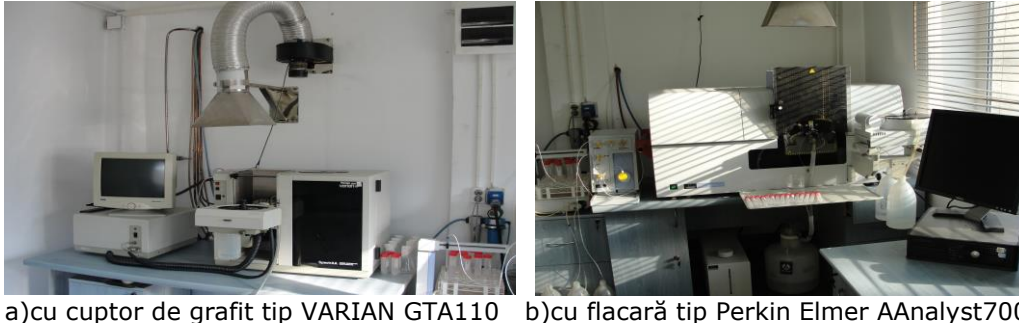
Fig.32. Spectrometru de absorbție atomică pentru determinări de metale a) cu cuptor de grafit; b) cu flacără
