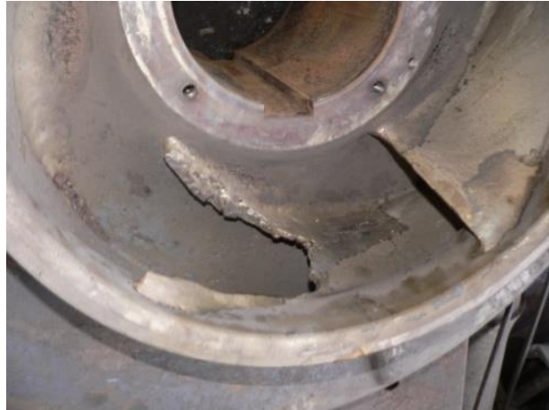
Fig. 1. 24 Rotorul pompei PRO 10-195 ce echipează SP Jidoaia, erodat cavitațional
