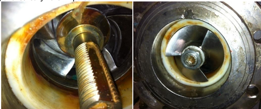
Fig. 7. 32 Rotor model reproiectat la scara 1:5.7 instalat în standul experimental din Laboratorul de pompe de la UPT: fără impulsor (stânga) și cu impulsor (dreapta).
