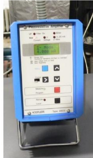
Fig. 2. 22 Amplificatorul piezorezistiv de presiune [3]
