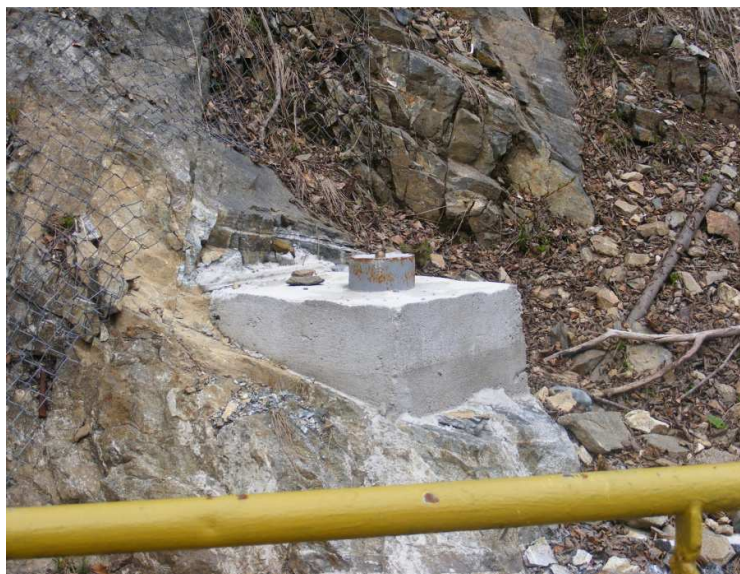
Fig. 6.19. Barajul Petrimanu- Reper fix din rețeaua de nivelment
