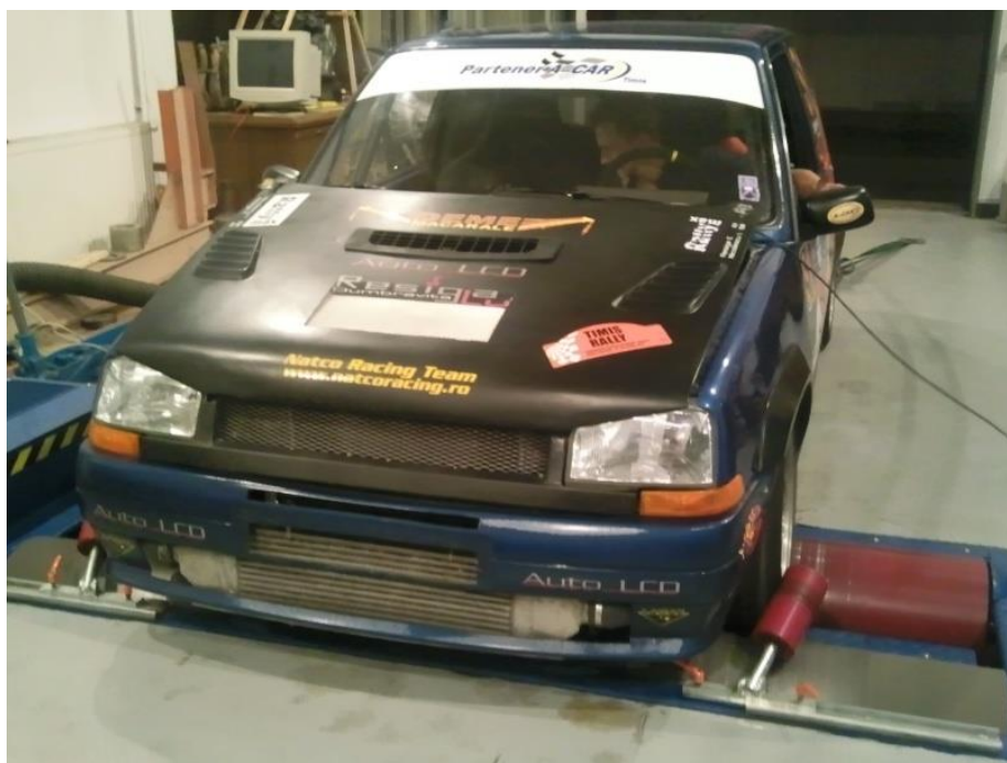
Fig.5.1. Motorul testat Volvo 440 turbo, 1.7 MPI ce echipează Renault 5 GTT (vehicul special dedicat competițiilor sportive profesionale)
