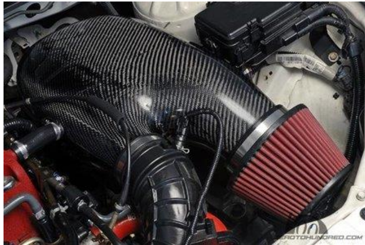
Fig.2.17. Filtru de aer conic pentru tuning
