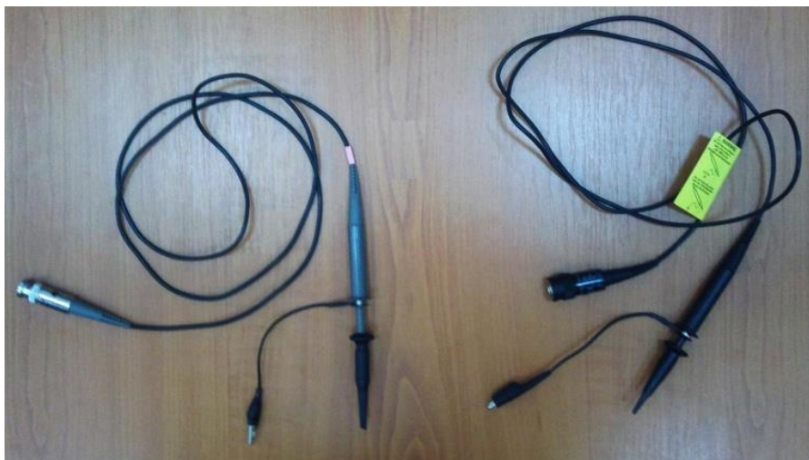
Fig. 4.7. Sonde de tensiune Tektronix P2220
