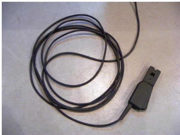
Fig. 4.4 Clemă pentru determinare turație motor
