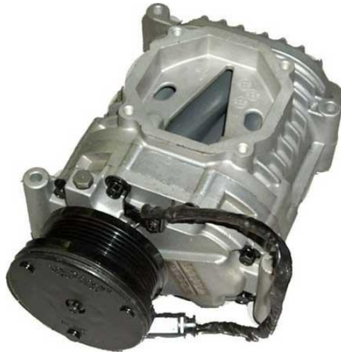
Fig. 2.23 Compresor mecanic pentru tuning
