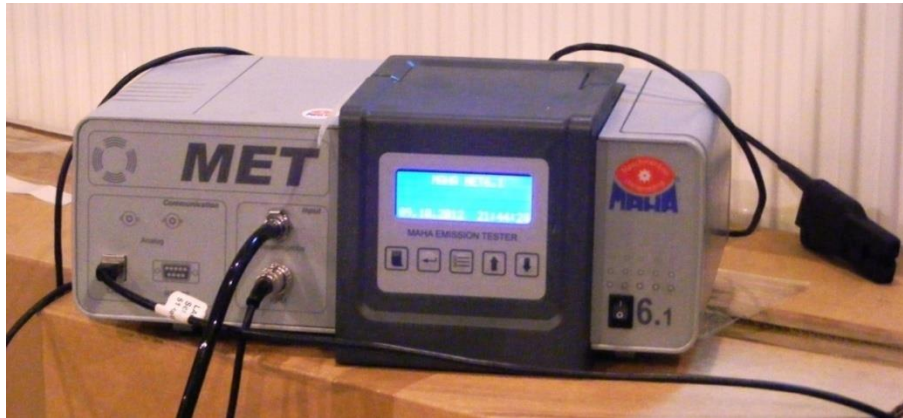
Fig.4.2 Echipament analiză gaze, Maha MET 6.1
