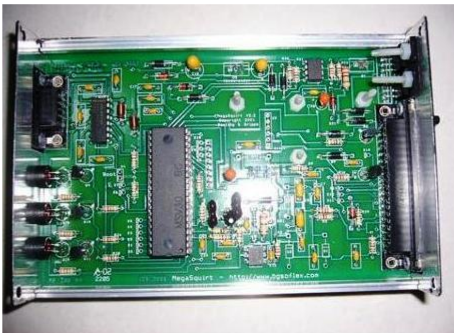
Fig. 2.27 Unitate ECU programabilă deschisă [114]
