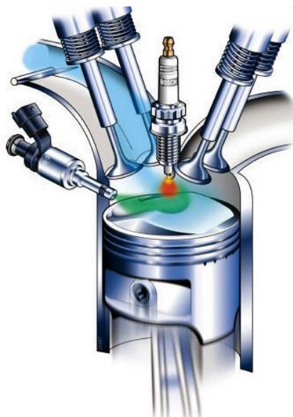
Fig. 5.4. Cameră de ardere motor cu injecție directă de combustibil [115]
