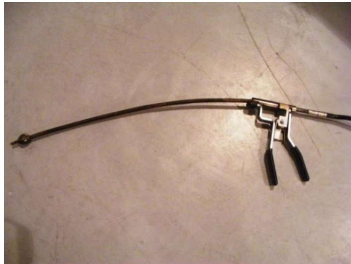
Fig. 4.3. Probă pentru măsurarea noxelor
