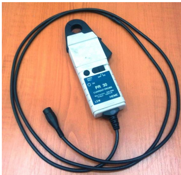
Fig. 4.6. Sondă de curent marca HEME
