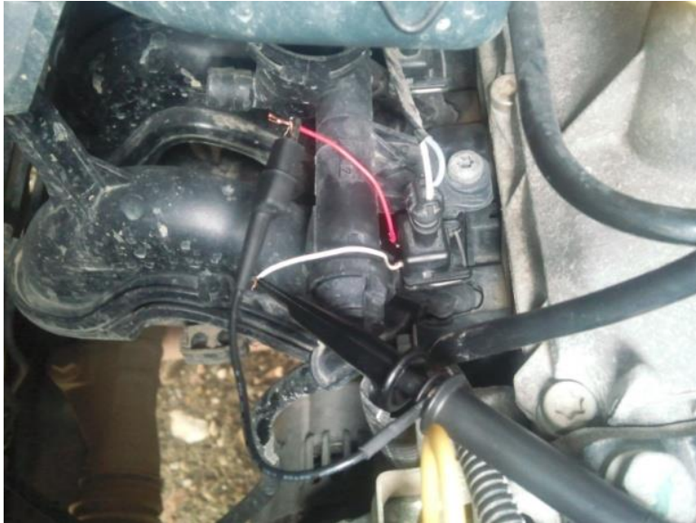
Fig. 4.20. Conectarea sondei de tensiune pentru determinarea tensiuni pe injector
