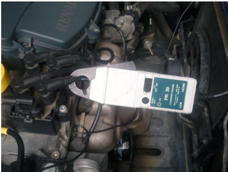
Fig. 4.21. Conectarea sondei de curent pentru determinarea momentului aprinderii
