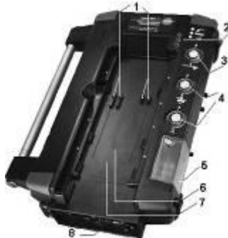
Figura 5.30. Unitatea de analiză, vedere de sus [25]: 1 – contactoare electrice; 2 – leduri de control; 3 – filtrul pentru particule solide; 4 – filtre de reținere particule din aerul aspirat; 5 – colectoare de condens; 6 – celule de analiză; 7 – sistem integrat de determinare a vitezei și presiunii gazelor; 8 – conexiuni.
