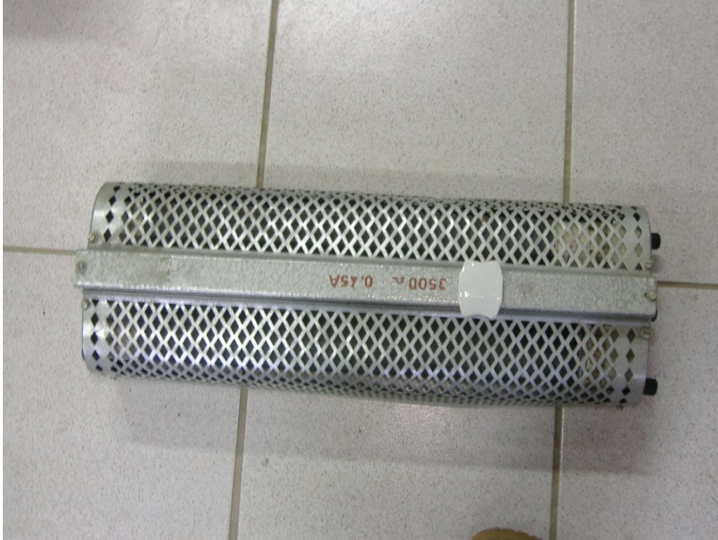
A2.1 Reostat folosit pentru încărcarea generatorului
