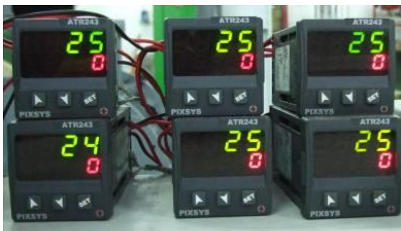
Figura 5.14. Exemplu de vizualizare a temperaturilor cu convertorul Pixsys ATR 243 ABC.
