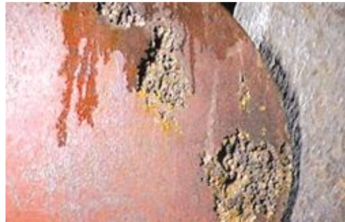
Fig. 1.2 Rotorul Kaplan distrus prin eroziune cavitațională, [56].
