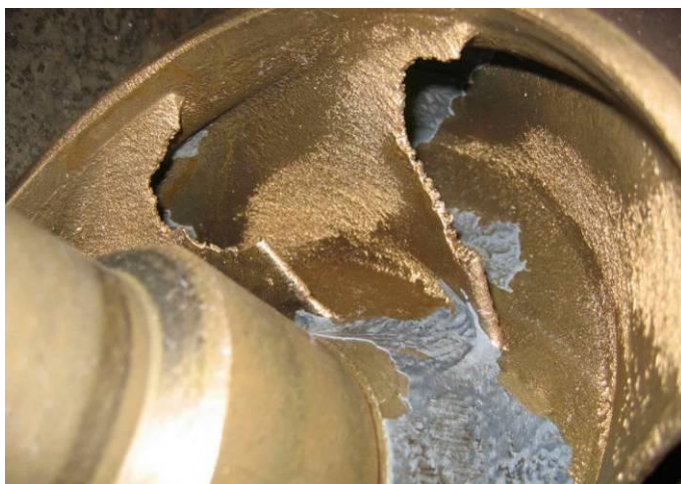
Fig. 1.3 Rotorul de pompă distrus prin eroziune cavitațională, [57].
