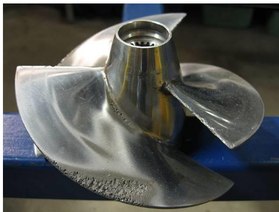
Fig. 1.4 Elice navală distrusă prin eroziune cavitațională, [58].
