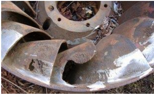
Fig. 1.1 Rotorul Francis distrus prin eroziune cavitațională, [55].
