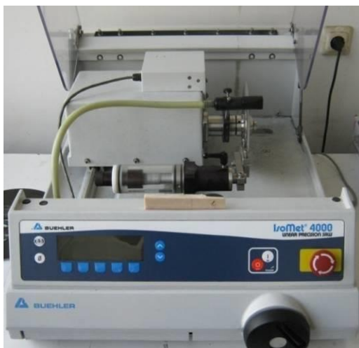
Fig. 2.23 Aparatul de taiat cu pânză BUEHLER 4000
