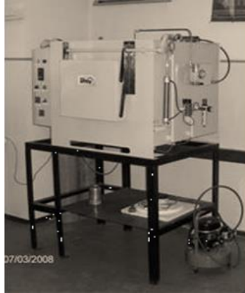
Fig. 2.2 Cuptorul de tratamente termice cu atmosfera controlată
