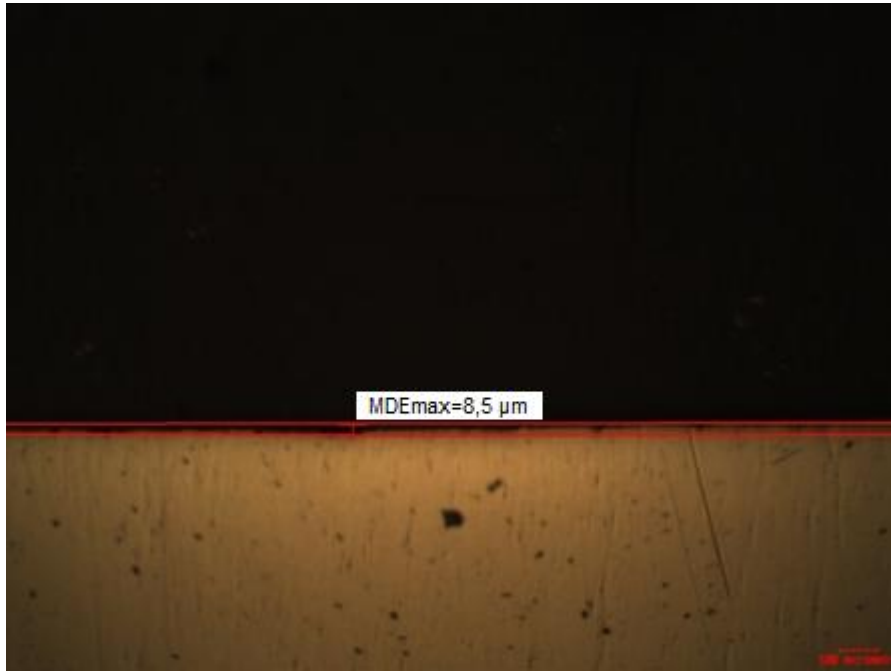
Fig. 2.133 Aspectul metalografic în secțiune transversală a probei din oțel C3(12/6) testată pe T2, stare neatacată, cu evidențierea adâncimii maxime a cavitației, x4
