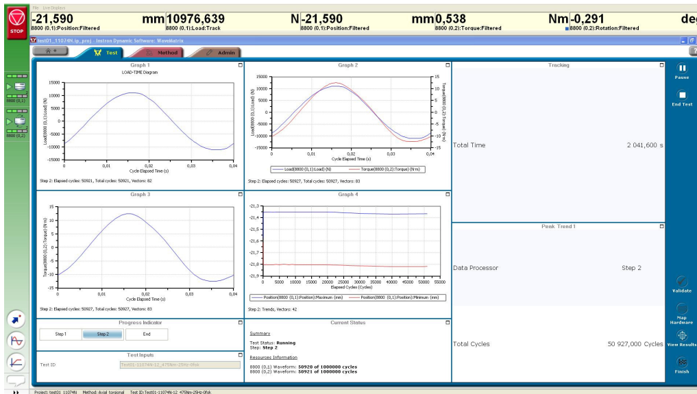
Fig. 5.28. Interfața principală a programului de comandă și monitorizare Instron WaveMatrix în timpul unei încercări multiaxiale proporționale
