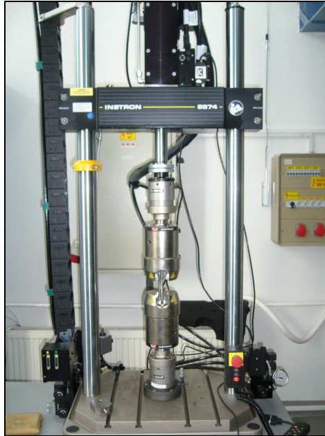
Fig. 5.27. Mașină universală de încercat la oboseală multiaxială Instron 8874 în dotarea Laboratorului de Încercări de Materiale din cadrul Institutului de cercetare BAY-LOGI din Miskolc
