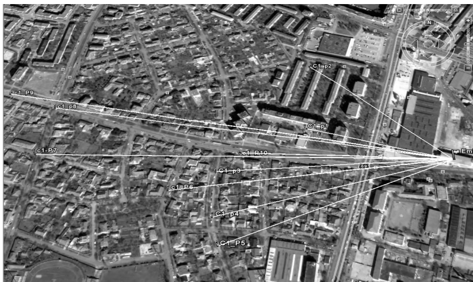
Fig. 5.8a Amplasarea emițătorului și a punctelor de măsurare din campania 1
