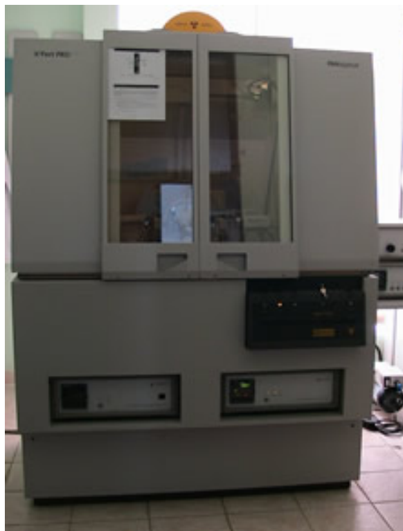
Figura 2.2. Difractometrul de raze X
