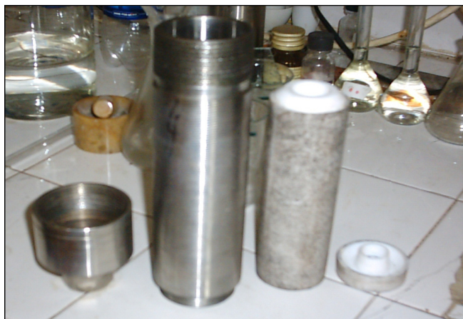
Figura 2.1. Autoclava utilizată în sinteza hidrotermală
