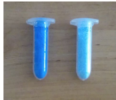
Figura 5.3. Imaginea materialelor pe bază de ZnAl_2O_4:Co^{2+} (raport molar Zn:Al:Co = 1:2:0,1) și ZnAl_2O_4:Ni^{2+} (raport molar Zn:Al:Ni = 1:2:0,1)
