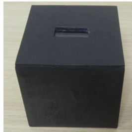
Figura 5.5. Cutie neagră utilizată la testarea \text{ZnAl}_2\text{O}_4 dopat cu ioni de \text{Eu}^{3+} și \text{Tb}^{3+}
