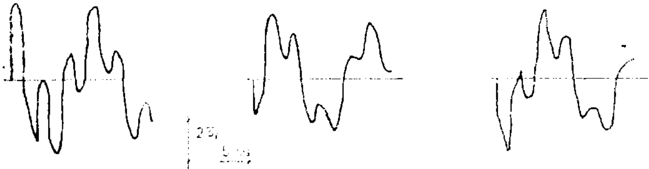
Fig.3.7. Tensiunile la capătul terminal al liniei pentru unghiul inițial de conectare \varphi I = \pi/2 , conectare simultană l=400 km, \tau_1=1,35 ms, \tau_0=1,67 ms, \rho_{sol}=100\Omega m , U_n=400 kV
