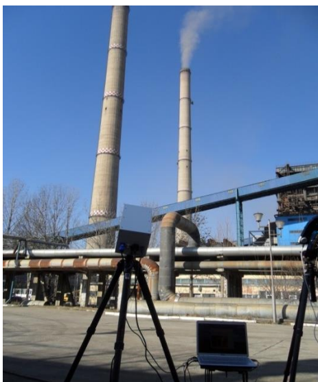
Figura 3.13 Camera IR în campania de măsurători de la Halânga
