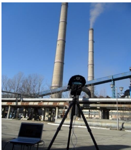
Figura 3.29. Camera UV în campania de măsurători de la Halânga
