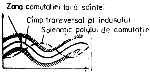
Figura nr.2.16. Solenația transversală a indusului și cea a polilor de comutație în zona de comutație
