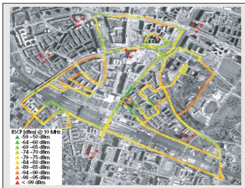
Figura 5.3. Nivelul de semnal pe traseul din zona de test
