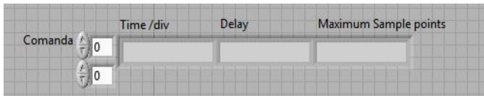
Figura 4.19a Linia de comandă trimisă pentru configurarea bazei de timp a osciloscopului LeCroy
