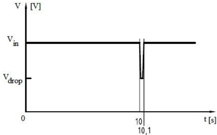
Figura 4.31 – Forma de undă generată la intrarea ECU-ului pentru întreruperi de scurtă durată ale tensiunii de alimentare
