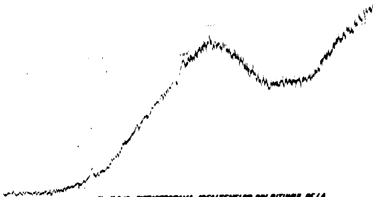
Fig. II.3.12 DIFRACTOGRAMA ASFALTENELOR DIN BITURUL DE LA RAFINARIA TELEAJEN
