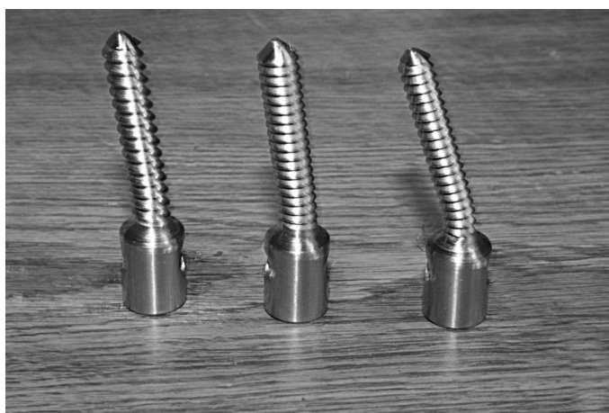
Figura 4.21. Formele deformate ale șuruburilor
