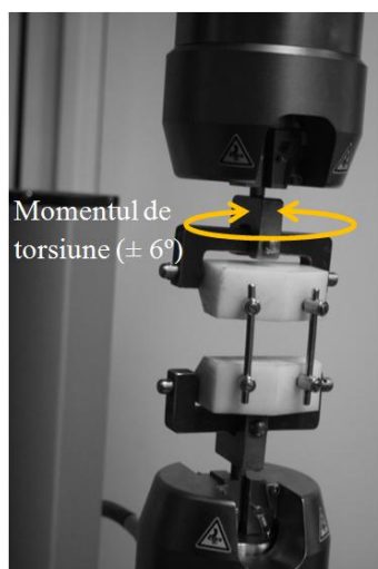
Figura 4.17. Solicitarea ciclică de torsiune
