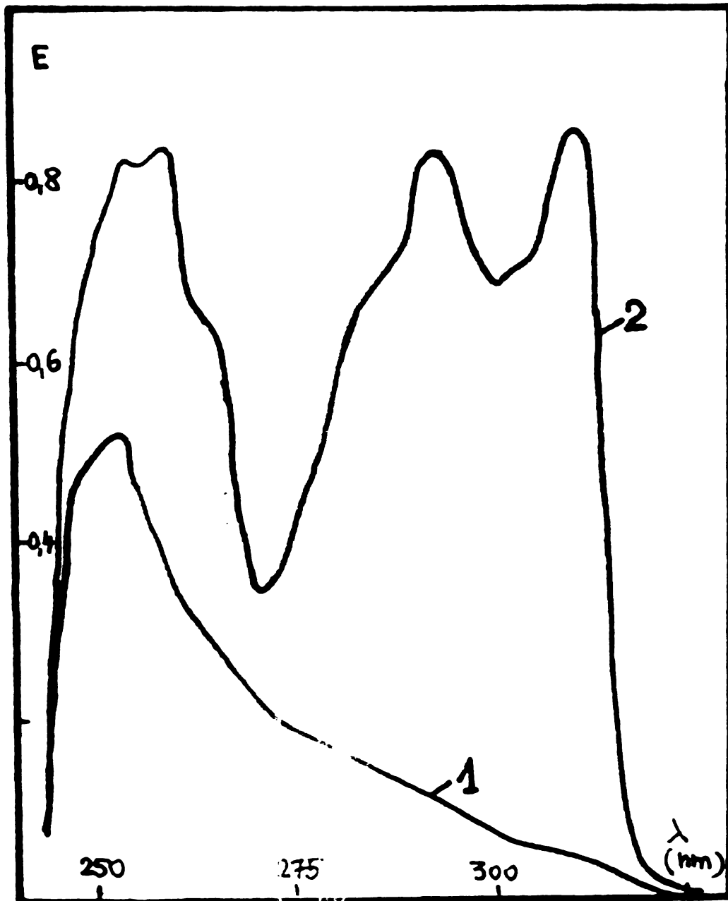
Fig. 14. Spectre de UV ale N -( N -fenilcarbamoil)-2-aminobenzimidazolului (1) și respectiv N -fenil- N' -(2-benzimidazoil)ureei (2).-
