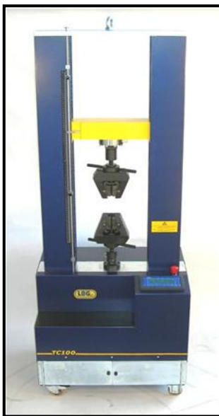
Figura 6.7 Echipamentul de încercare utilizat
