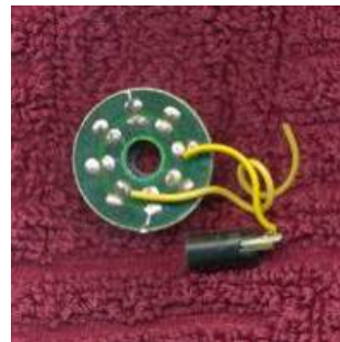
Figura 7.22 Capul LASER proiectat și realizat pentru microîmbinarea foliilor[20]
