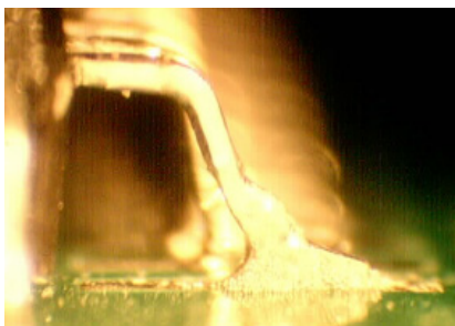
Figura 6.30 Microîmbinare rece-cauza temperatura insuficientă pentru topirea aliajului
