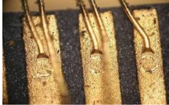
Figura 9.1 Microîmbinări în pană ale firelor din aur pe contacte din același material
