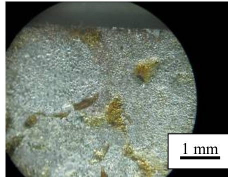
Figura 6.2 Umeectarea cu aliaj ecologic de lipit[29]
