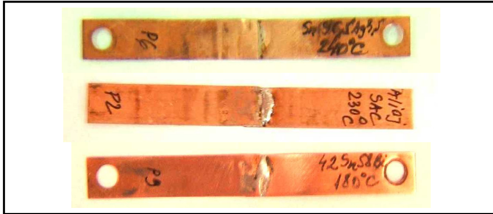
Figura 6.10 Probele obținute prin lipire eutectică : P6 cu aliaj de lipit Sn-Ag, P2 cu aliaj de lipit Sn-Ag-Cu, si P9 cu aliaj Sn-Bi
