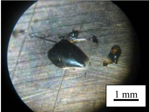
Figura 6.1 Particulă aliaj de lipit plasată pe suprafața curată [29]
