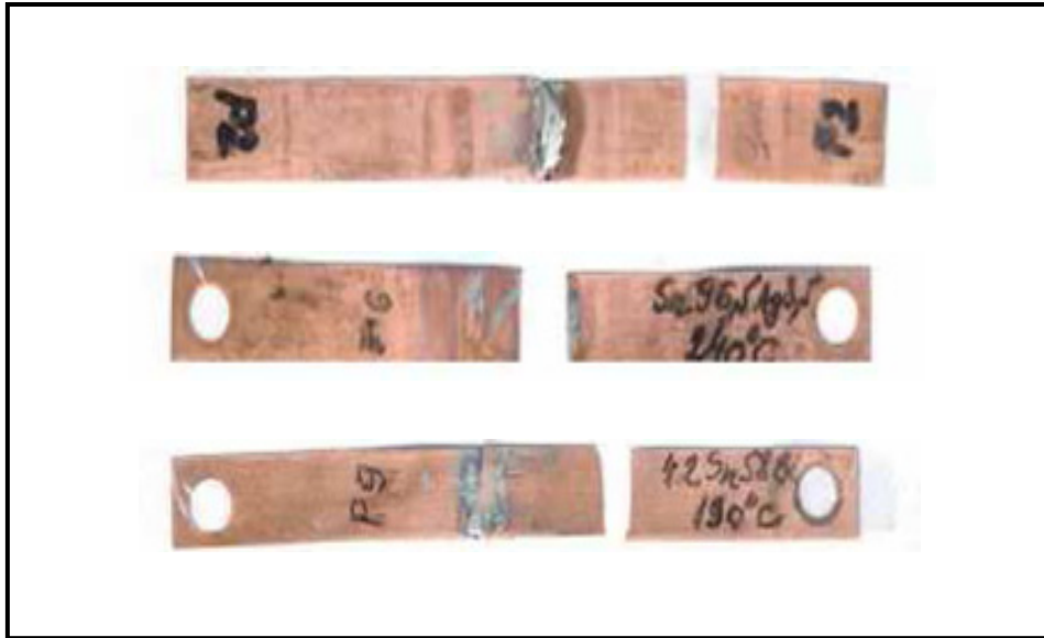
Figura 6.13 Probele după încercarea la tracțiune: P2 – cu aliaj SAC, P6 – cu aliaj SA și P9 cu aliaj SB
