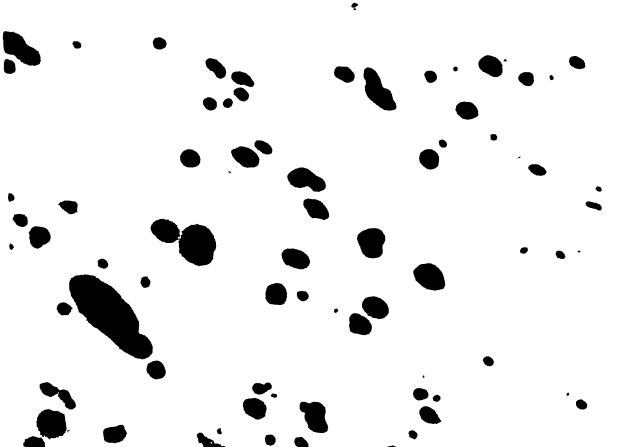
Fig. 3.40. - Incluziuni nemetelice pori numeroși la o sudură în CO 2 cu preîncălzire executată la o temperatură în jur de 0°C.
