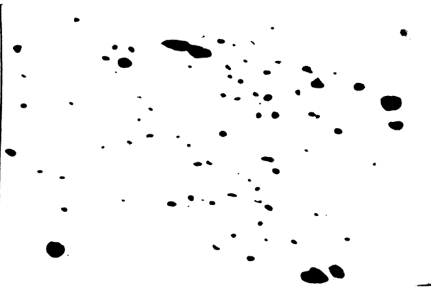
Fig. 3.39. - Incluziuni nemetelice la o sudură executată cu preîncălzire executată în CO 2 la o temperatură între + 10 și 20°C.
