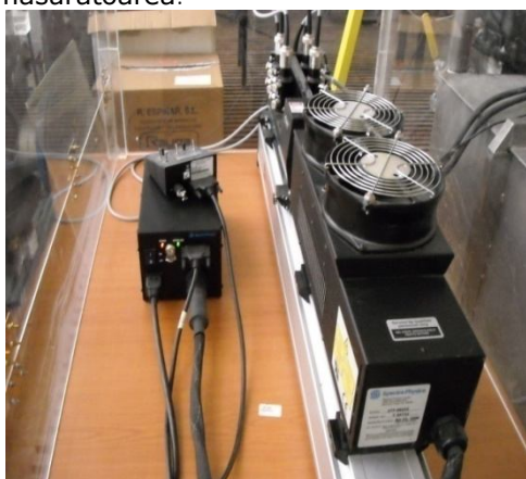
Fig. 2. 24 Sistemul de generare al razei laser.
