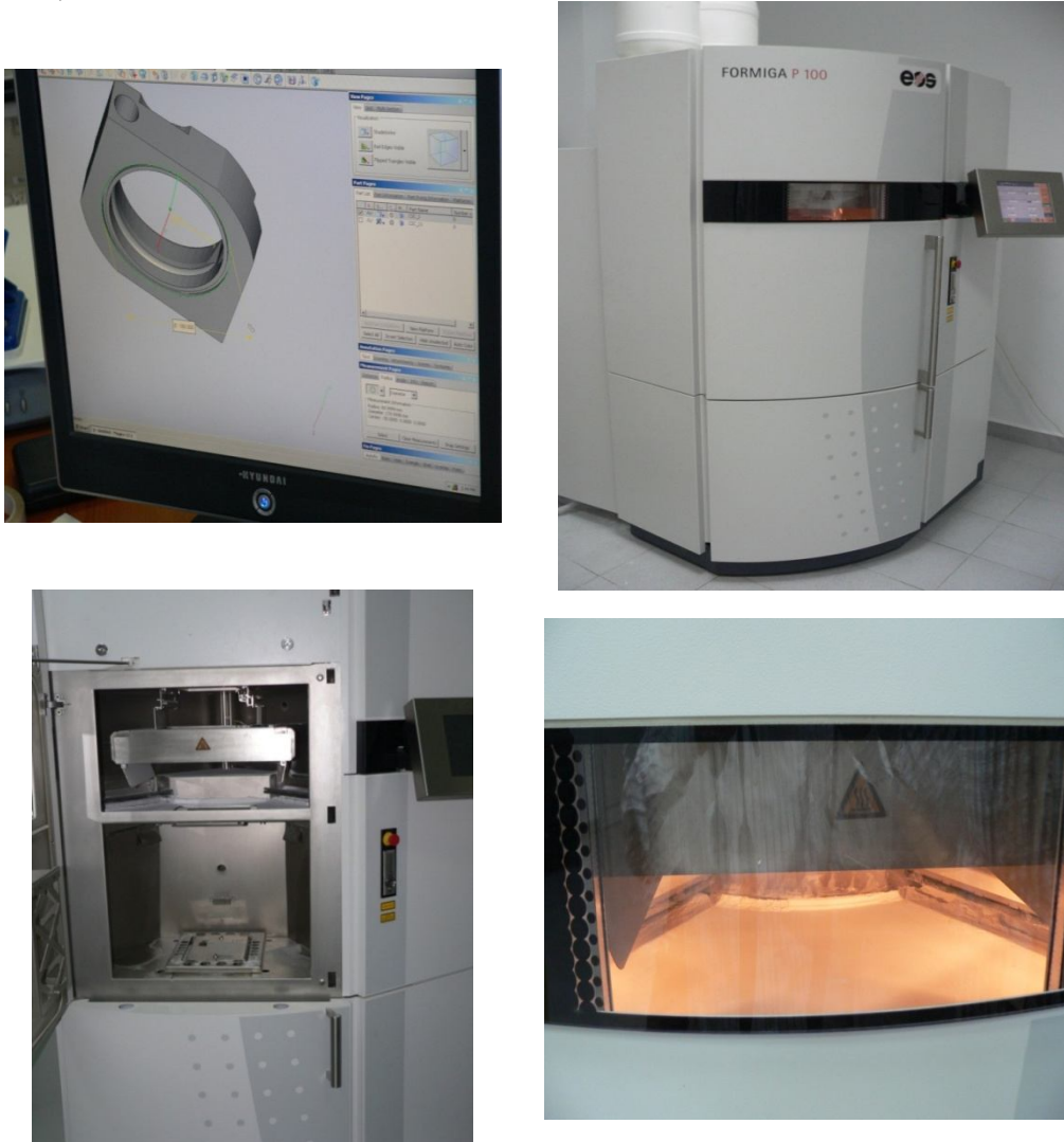
Fig. 3. 20 Realizarea camerei spirale prin metoda de rapid-prototyping.
