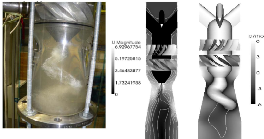
Fig. 6. 4 Vârtejul funie obținut pe standul experimental de la UPT, câmpul de viteză și forma vârtejurii funie obținut de Petit și alții [96].
