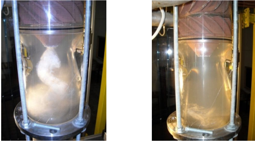
Fig. 2. 14 Vârtejul funie obținut cu noul generator de curgere cu rotație fără injecție de apă (stânga) și cu injecție de apă (dreapta) [29].
