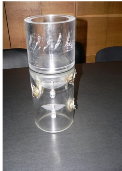
Fig. 2. 11 Secțiunea de testare împreună cu secțiunea cilindrică, varianta proiectată (stânga) și varianta executată (dreapta).
