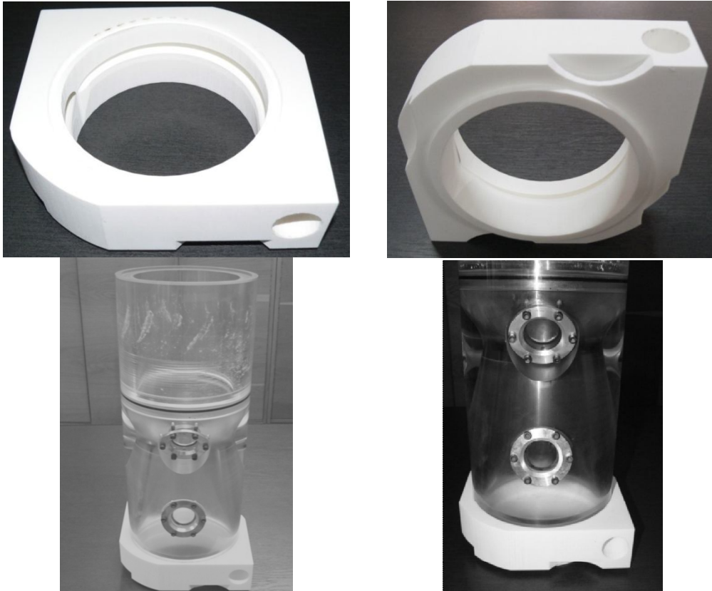
Fig. 3. 21 Camera spirală în urma realizării prin rapid-prototyping și asamblarea cu secțiunea de măsură.
