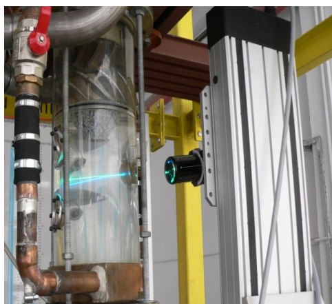
Fig. 2. 25 Sistemul LDV cu sonda de măsură în timpul măsurătorilor profilelor de viteză.
