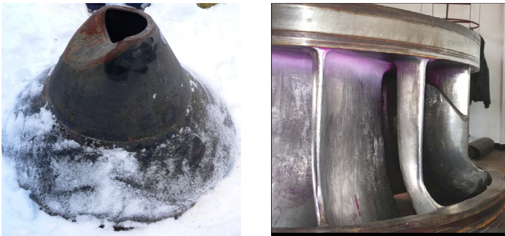
Fig. 1.20 Recuperarea ogivei după ce a fost îndepărtată de pe coroana rotorului – stânga; rupere de paletă – dreapta [46].
