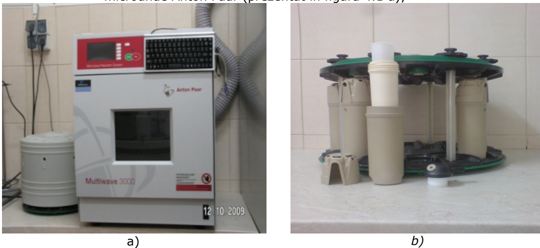
Fig. 4.1 Cuptorul cu microunde utilizat în sinteza de nanocristale (a); autoclave utilizate în sinteza de nanocristale (b)
