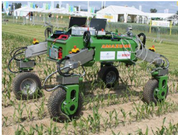
Fig. 2. 14. Robot autonom pentru agricultură conceput la Universitatea din Osnabrück în colaborare cu firmele Amazone și Bosch [*** Img, BoniRob]
