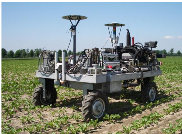
Fig. 2. 11. Robot autonom pentru combaterea buruienilor conceput la Universitatea din Wageningen, Olanda [Bakker, 2011]
