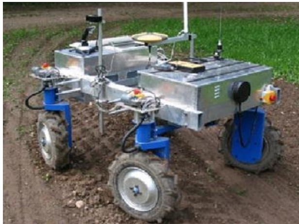
Fig. 2. 10. Robot autonom pentru combaterea buruienilor conceput la Institutul Danez de Științe Agricole, Danemarca [Slaughter, 2008]
