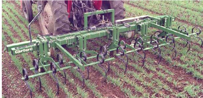
Fig. 2. 6. Prășitoare pentru cereale, ghidată prin vedere artificială [Home, 2002]
