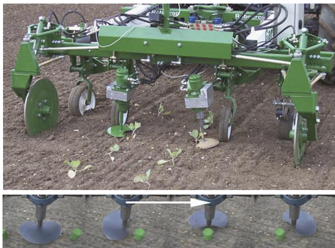
Fig. 2. 7. Disc rotativ prevăzut cu o secțiune pentru protejarea platelor cultivate [Tillett, 2007].
