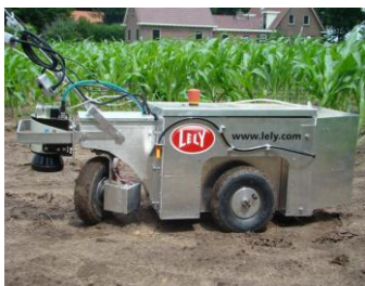
Fig. 2. 18. Robotul „Eyesonic” conceput la Universitatea din Wageningen, Olanda [*** Img, Eyesonic]
