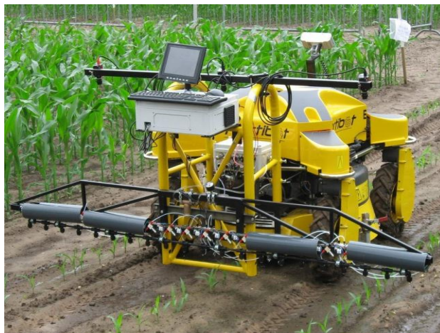
Fig. 2. 12. Robot autonom pentru protejarea culturilor agricole conceput la Universitatea din Aarhus, Danemarca [*** Img, Hortibot]
