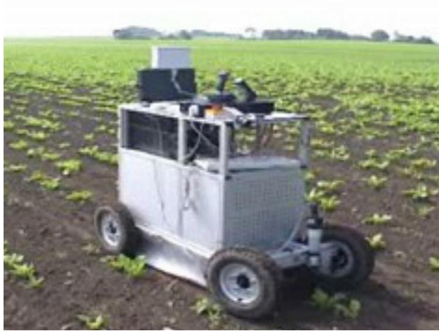
Fig. 2. 9. Robot autonom pentru combaterea buruienilor conceput la Universitatea din Halmstad, Suedia [*** Img, Lukas]
