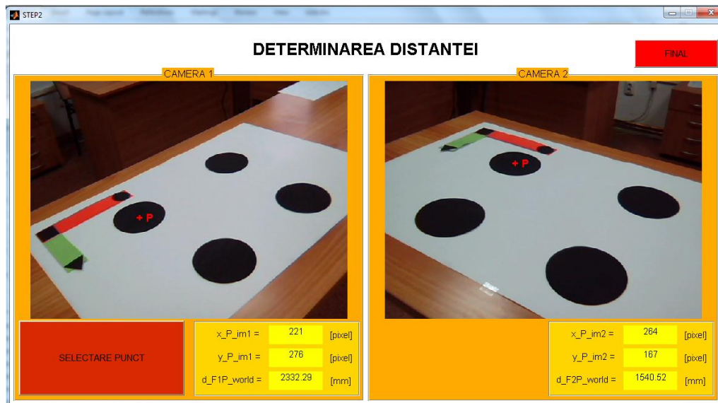
Fig. 6. 4. Interfața grafică a programului utilizat la măsurarea distanțelor prin vedere stereo
