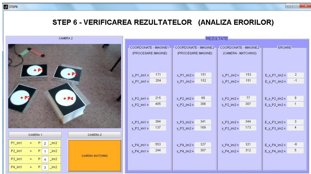
Fig. 7. 14. Verificarea preciziei de calibrare extrinsec
