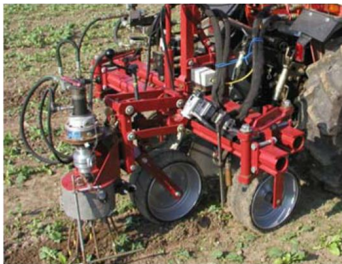
Fig. 2. 8. Prășitoare cicloidală „Querhacke” concepută la Universitatea din Osnabrück, Germania [Griepentrog, 2007]
