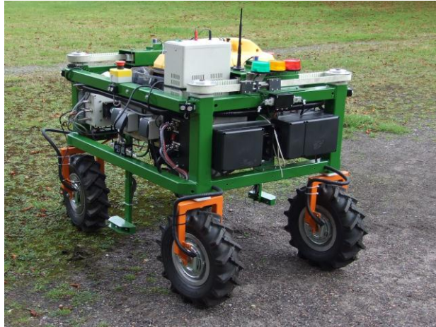
Fig. 2. 13. Robot autonom pentru combaterea buruienilor „Weedy” conceput la Universitatea din Osnabrück, Germania [*** Img, Weedy]
