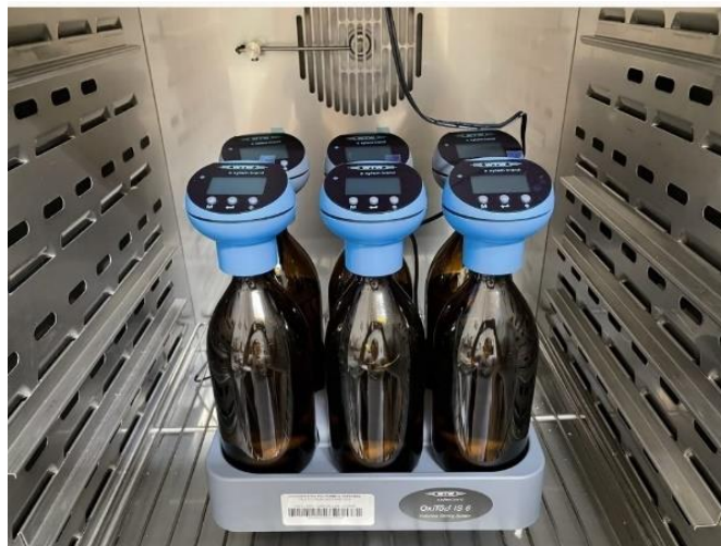
Figura 62 Sistemul Oxytop pentru determinarea oxigenului dizolvat
