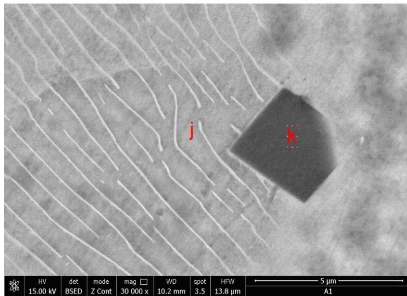
Figura 6.25. Microzonă 2 proba A1 - puncte de interes – analiză EDS, 30000x
