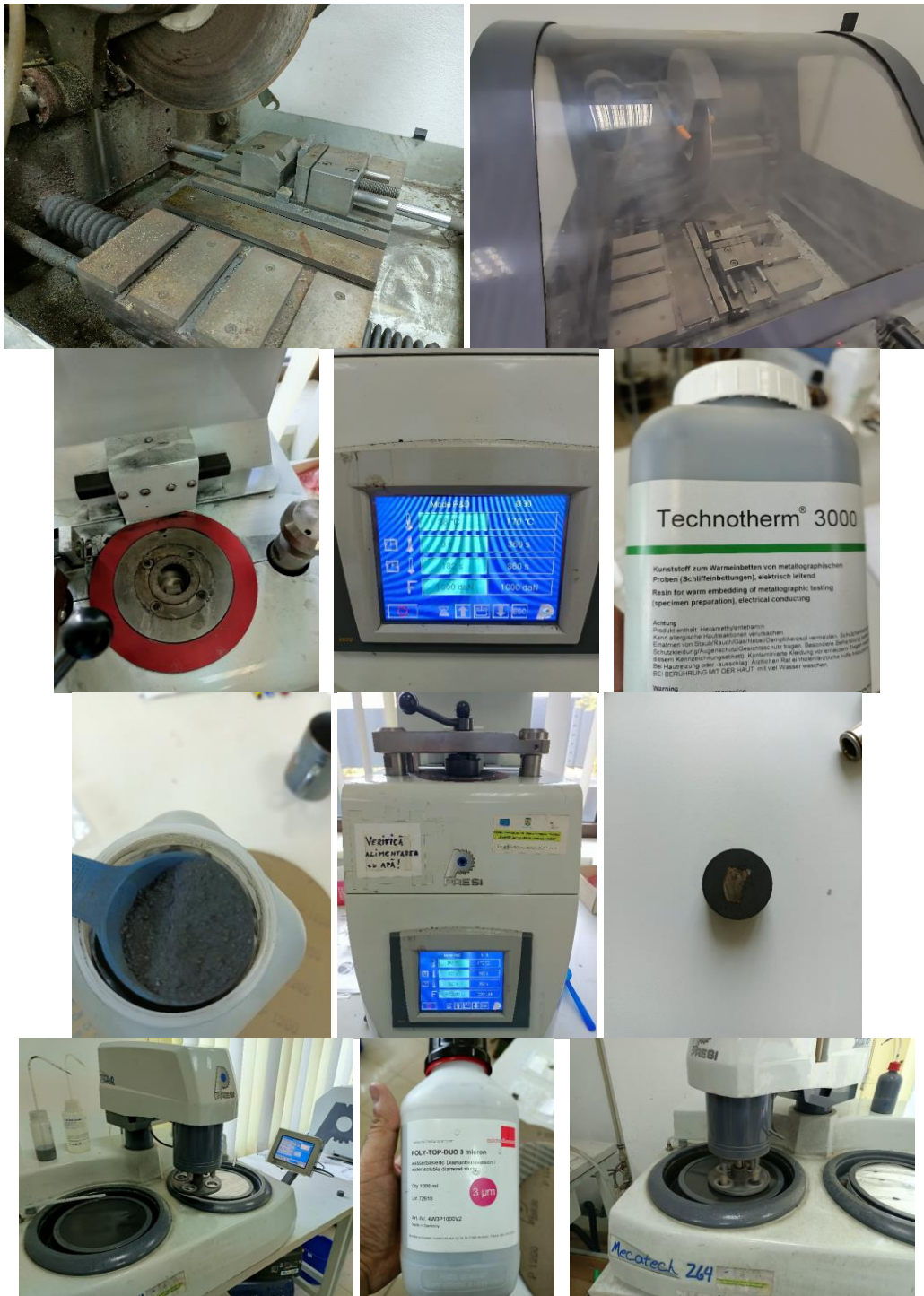
Figura 6.2 Aspecte din timpul pregătirii probelor
