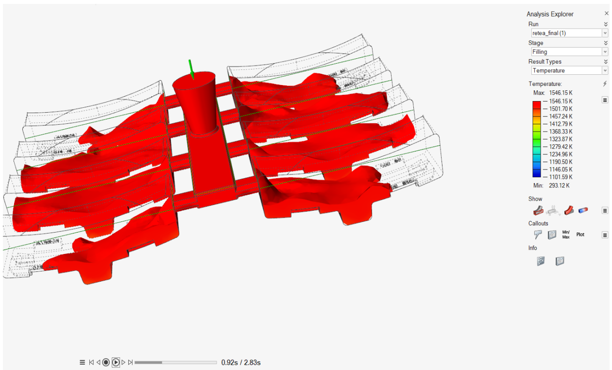
Figura 5.9. Turnare intermediară (0,92s)
