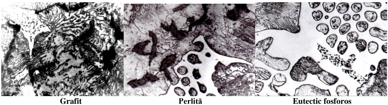
Figura 1.6. Structura fontei fosforoase, 400x [5,10]
