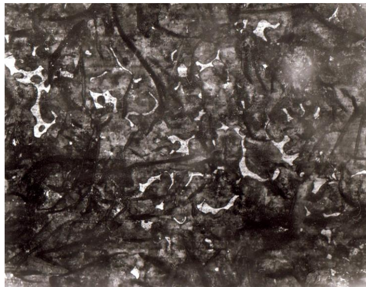
Figura 1.5. Modul de repartizare a eutecticului fosforos în fontele cenușii (200x) [5,10]
