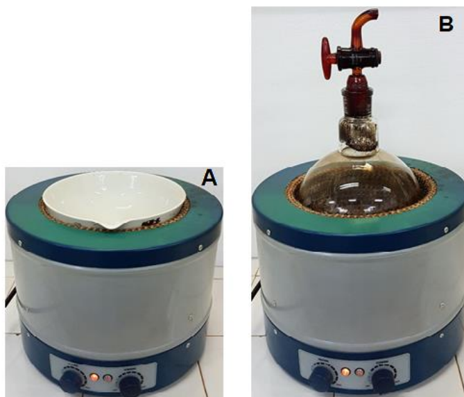
Figura II.1. Montajul utilizat pentru sinteza probelor în capsulă (în prezența aerului, A) respectiv în balon închis (în absența aerului, B).
