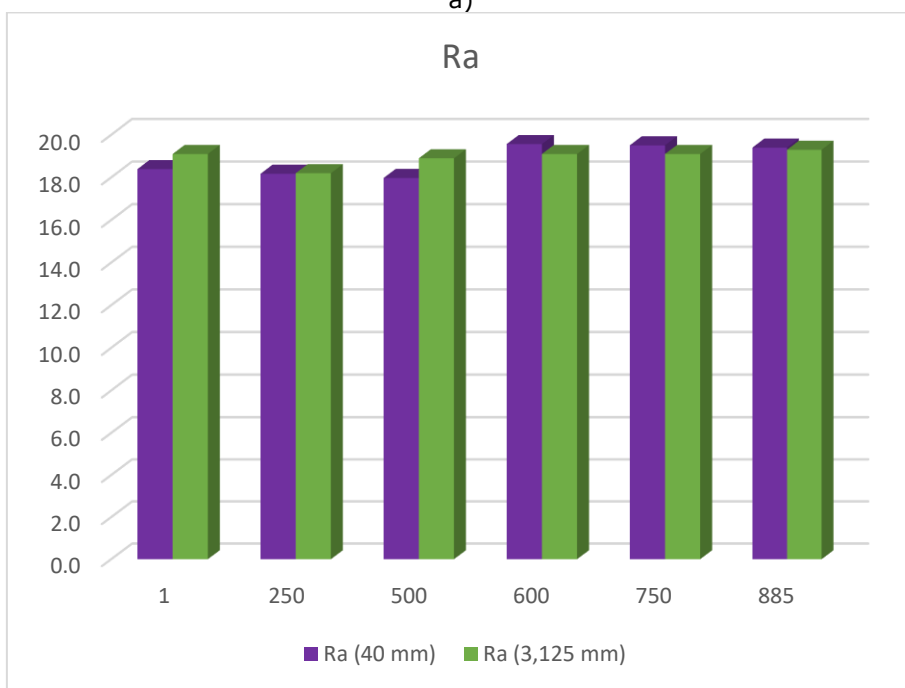
Figura 7.9 Grafice valorile parametrilor Rz și Ra pentru cala comercială de rugozitate cu Rz de 80 μm și Ra de 18 μm
