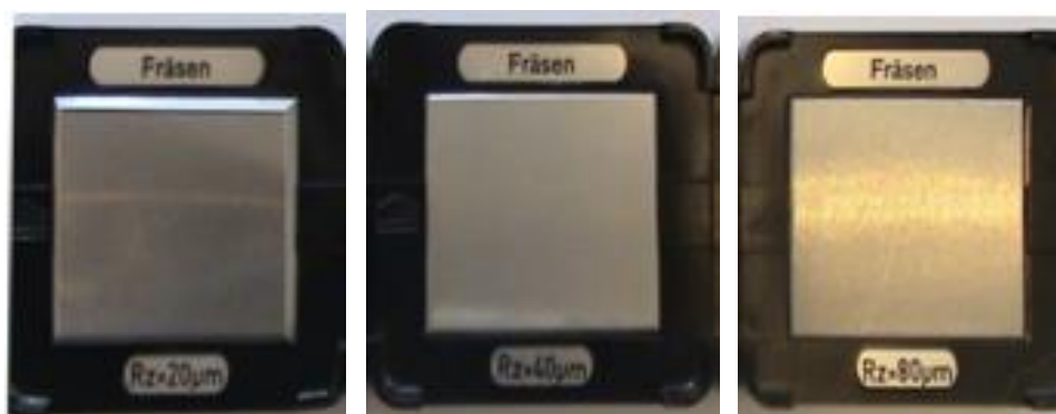
Figura 7.2. Cale comerciale de rugozitate cu valorile nominale ale parametrilor de rugozitate Rz 20, 40 și 80 µm și Ra 3.6, 9.8, 18 µm
