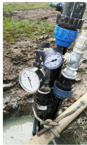
Fig. 5.10 Proba de presiune a sondei geotermale
