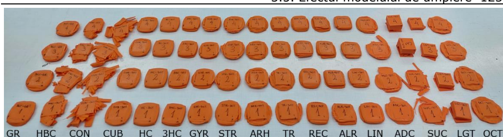
Fig. 3.34. Epruvetele deformate în funcție de modelul de umplere
