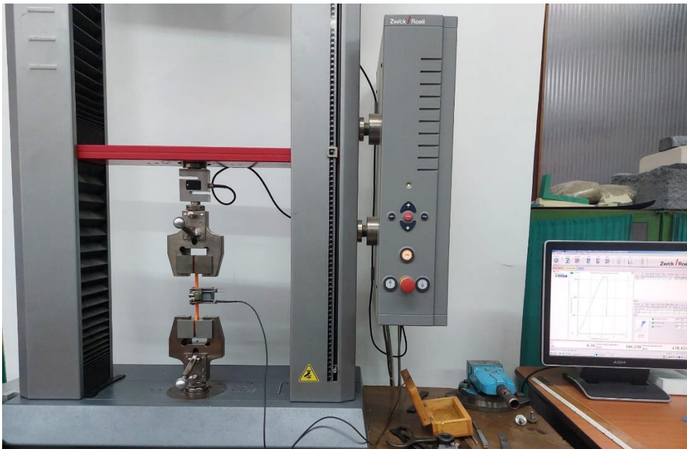
Fig. 2.5. Mașina universală de testare Zwick Roell 005 de 5 kN
