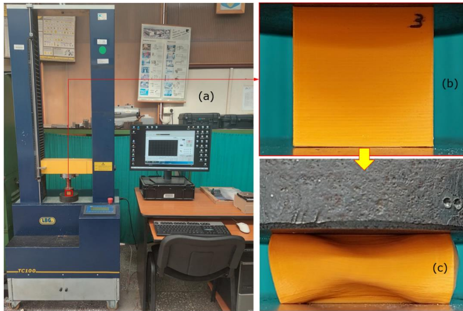
Fig. 3.3. Mașina universală de testare LBG TC100 de 100 kN
