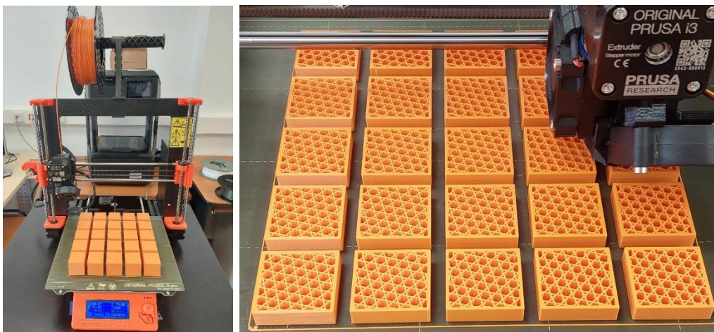
Fig. 3.2. Vedere de ansamblu a imprimantei Original Prusa i3 MK3 (stânga) și a epruvetelor din PLA printate 3D (dreapta)
