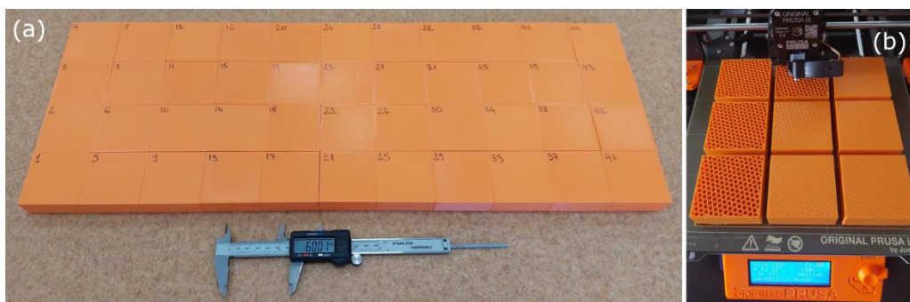
Fig. 5.2. Epruvetele printate 3D utilizate pentru testele de impact: imagine de ansamblu (a) și procesul de fabricație (b)
