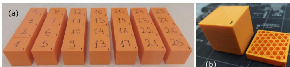
Fig. 6.1. Epruvetele printate 3D utilizate pentru testele de oboseală: imagine de ansamblu (a) și structura internă (b)
