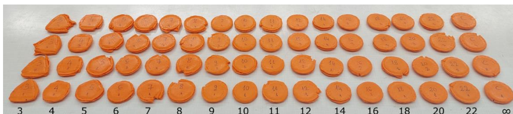
Fig. 3.50. Epruvetele deformate în funcție de forma acestora
