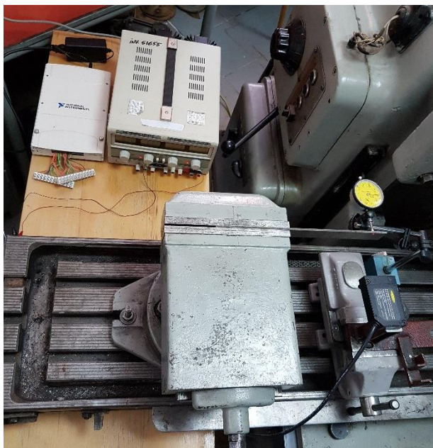
Figura 4.5: Sistemul de achiziție constând din senzorul optic LG10A56PU, sistemul de achiziție multifuncțional NI USB-6259 M și sursa de alimentare dublă SAD
