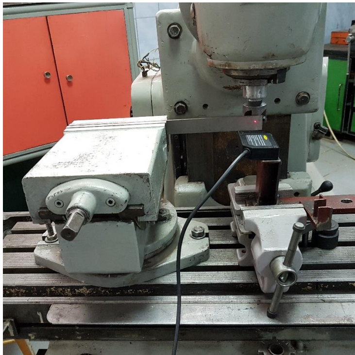
Figura 4.4: Mașina-unealtă și senzorul laser LG10A56PU cu focalizare pe piesa de prelucrat
