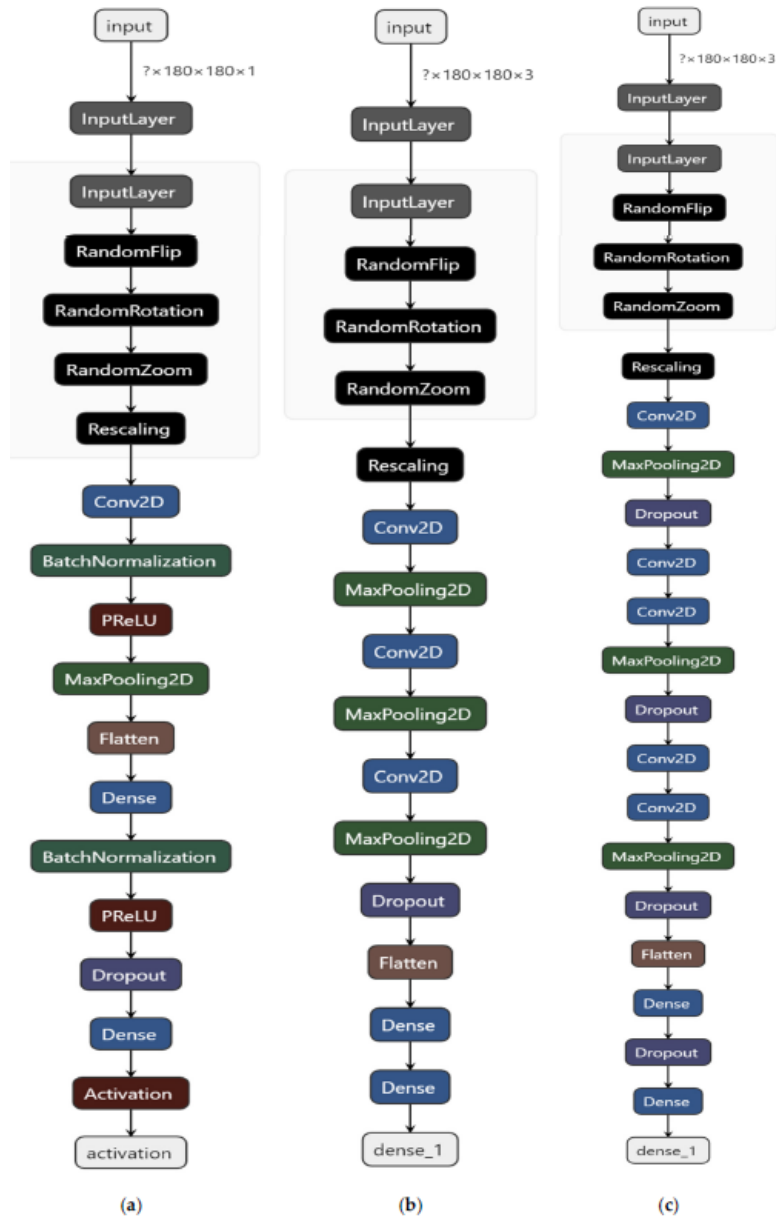
Figura 5.4.3 Arhitecturi 2D-CNN personalizate: (a) Model S secvențial – 1 strat convoluțional; (b) Model M secvențial – 3 straturi convoluționale; (c) Model L secvențial – 5 straturi convoluționale.
