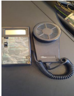
Luxmetru - aparat măsurat fluxul luminos, intensitatea luminii
