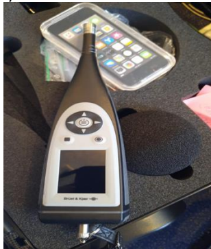
Sonometru –aparat de măsurare zgomote
