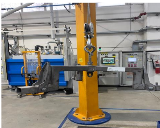
a. Dispozitiv utilizat la încărcare piese
