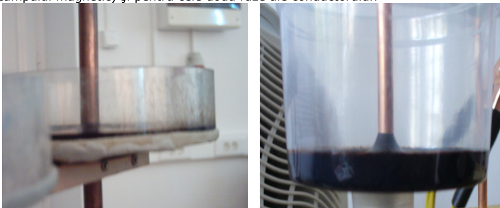
Fig.4.82. Denivelarea ferofluidului la valoare maximă a curentului aplicat în cazul unui conductor cu rază a_1 = 5\text{mm} (stânga) și cu rază a_2 = 3\text{mm} (dreapta).
