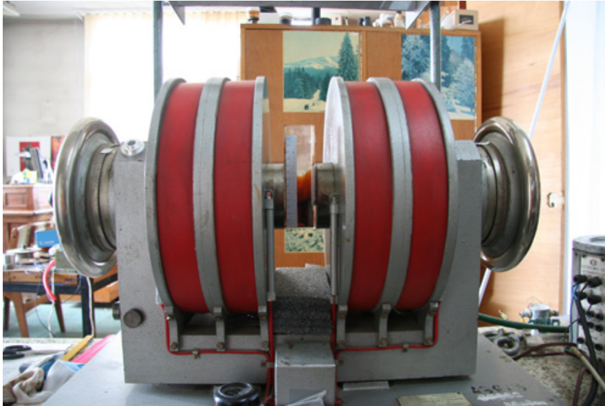
Fig.4.15. Electromagnetul Weiss utilizat în determinările experimentale.
