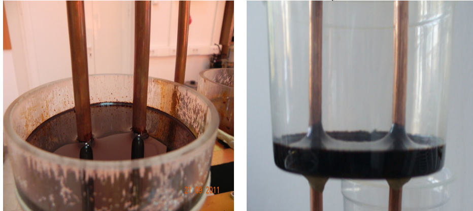
Fig.4.85. Denivelarea ferrofluidului la valoare maximă a curentului aplicat în cazul a două conductoare cu rază a_1 = 5\text{mm} (stânga) și cu rază a_2 = 3\text{mm} (dreapta).
