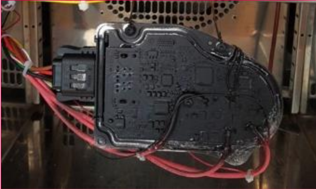
Fig. 6.5. Pregătire TCU pentru monitorizarea temperaturi
